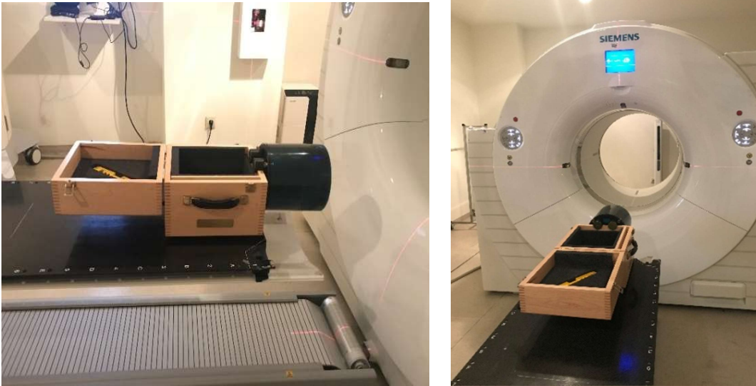
Şekil 23. Çalışma için kurulumu yapılmış capthan fantom
