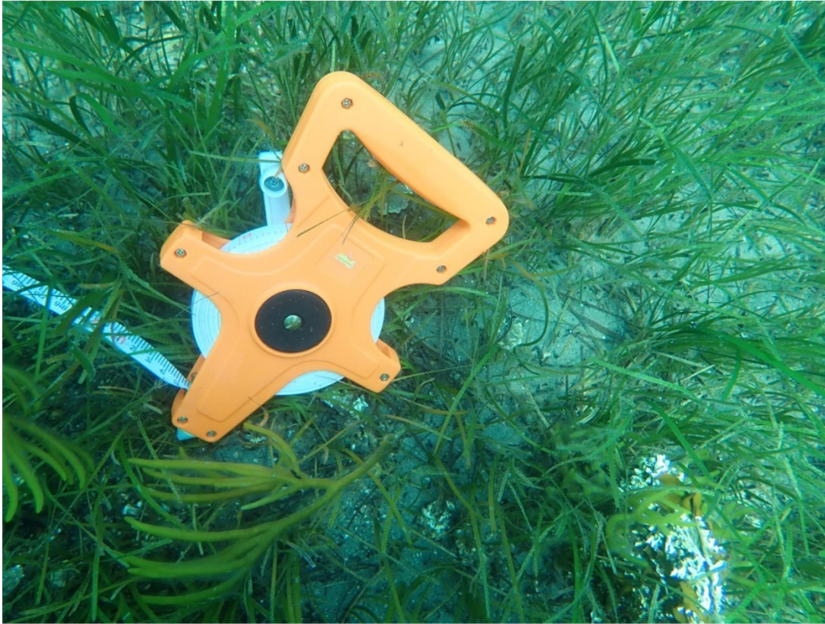
Şekil 5. Su altında transekt ölçümü için kullanılan şerit metre (Orijinal)
