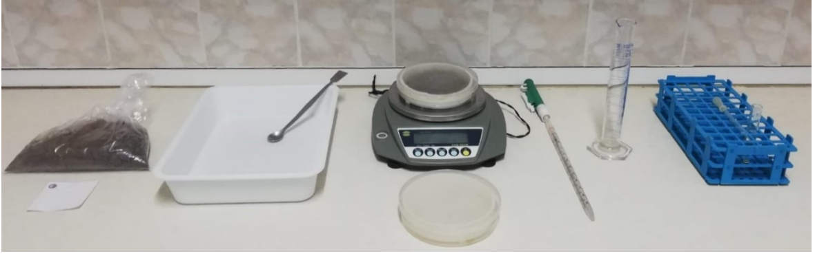
Şekil 7. Geliştirilmiş Baermann Huni Yöntemi'nin aşamaları ve kullanılan ekipmanlar
