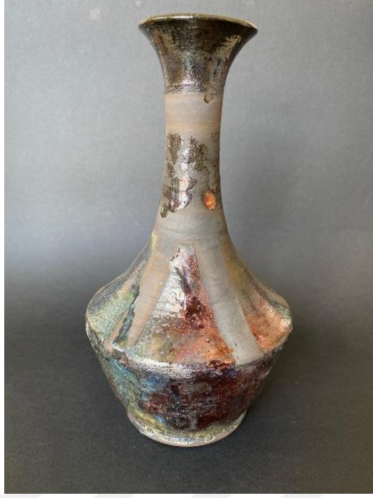
Şekil 20. 1100 °C sıcaklıkta deneme 30 ile sırlanmış form
