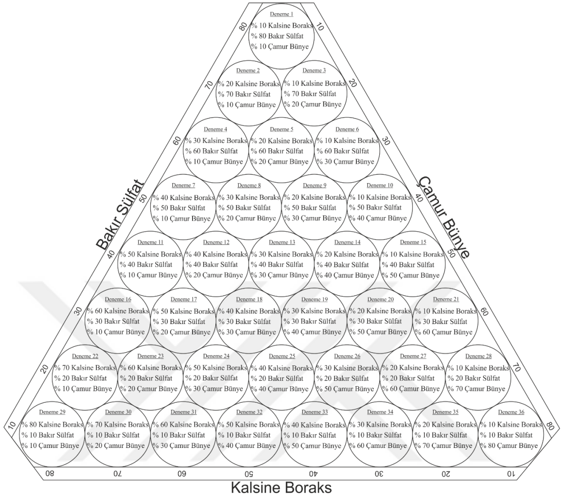
Şekil 15. Sır bünye için hazırlanan üçlü diyagram
