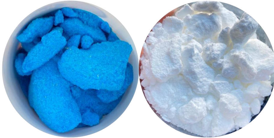
Şekil 11. Sır denemelerinde kullanılan bakır sülfat ve kalsine boraks
