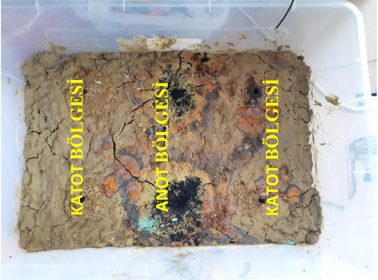
Şekil 16. Elektrokinetik test sırasında nem içeriğindeki farklılıklar sonucu oluşan çatlaklar
