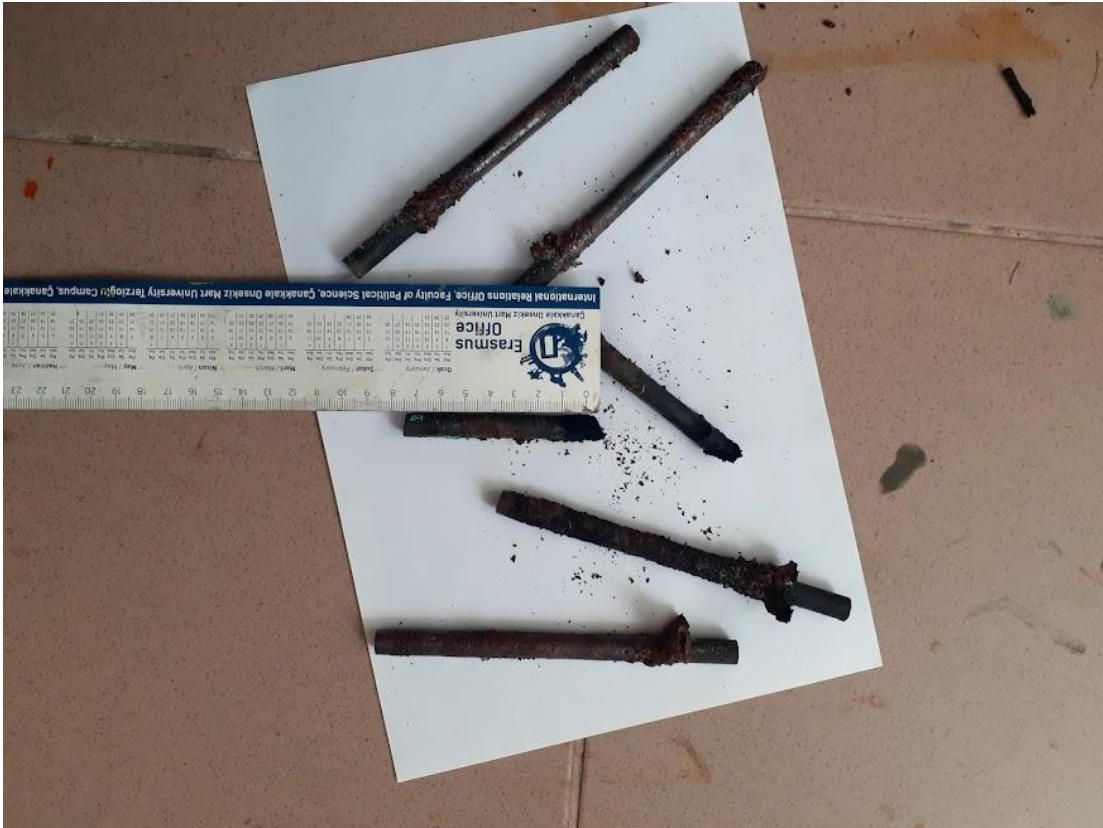
Şekil 14. Arıtım çalışması esnasında deforma olan grafit elektrotlar
