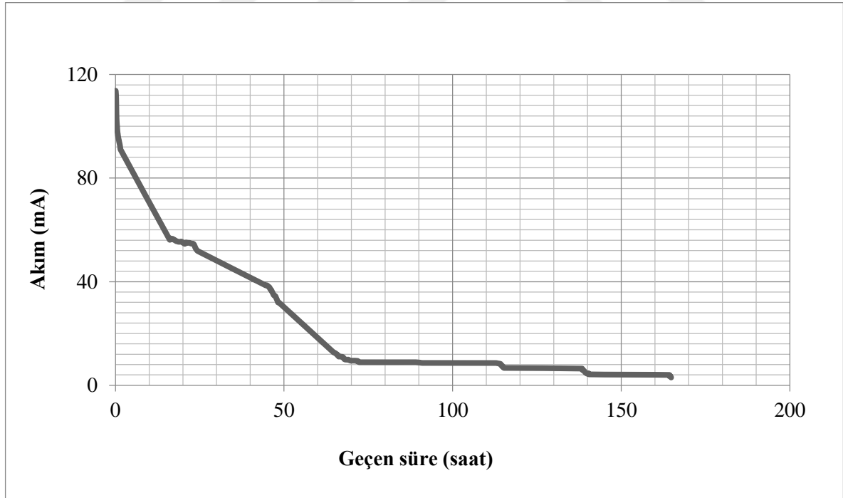
Şekil 7. Bakır tel ile yapılan çalışmada geçen süre ve akım değerlerinin ilişkisi
