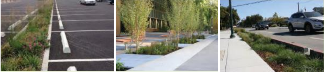
Şekil 3. Yağmur suyu bitki şeridi örnekleri. “Green Infrastructure Design Guide”, San Mateo Countywide Water Pollution Prevention Program, 2020, s. 38-39-40 kitabından alınmıştır.
