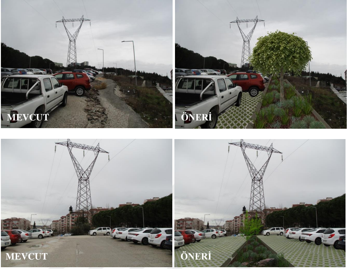
Şekil 58. Hastane otoparkı yağmur suyu bitki şeridi ve geçirgen kaplama önerisi (Orijinal, 2022)
