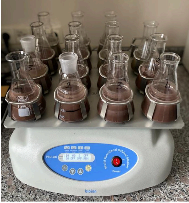
Şekil 11. Liç testleri için orbital çalkalayıcıda örneklerin karıştırılması
