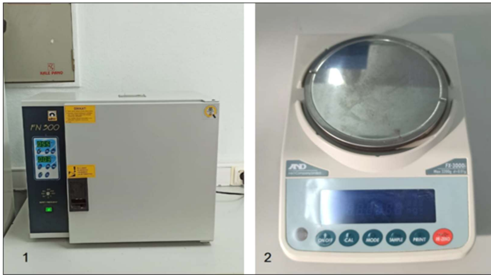
Şekil 3. Kurutma işleminde ve ağırlık ölçümünde kullanılan Etüv (1) ve Hassas Terazi (2)
