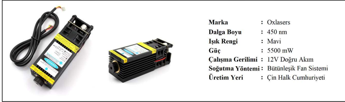
Şekil 4. Denemelerde kullanılan lazer modülüne ait görüntüler
