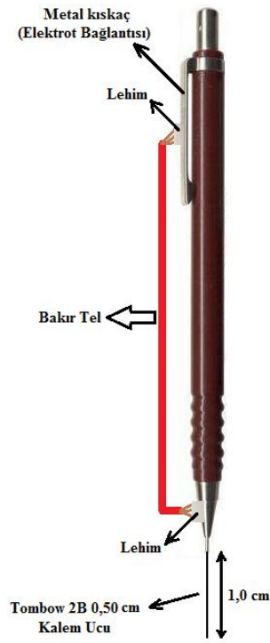
Şekil 3.1. Çalışma elektrodunu sabitlemek amacıyla kullanılan, elektriksel bağlantısı yapılmış Rotring (Germany) Tikky 0,50 mm mekanik uçlu kalemi
