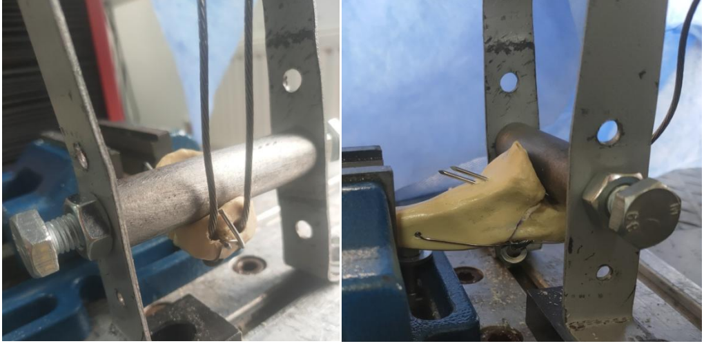
Şekil 15: Kemik modelinin biyomekanik test cihazına bağlanması ve çelik tel ile triceps gücünün değerlendirilmesi
