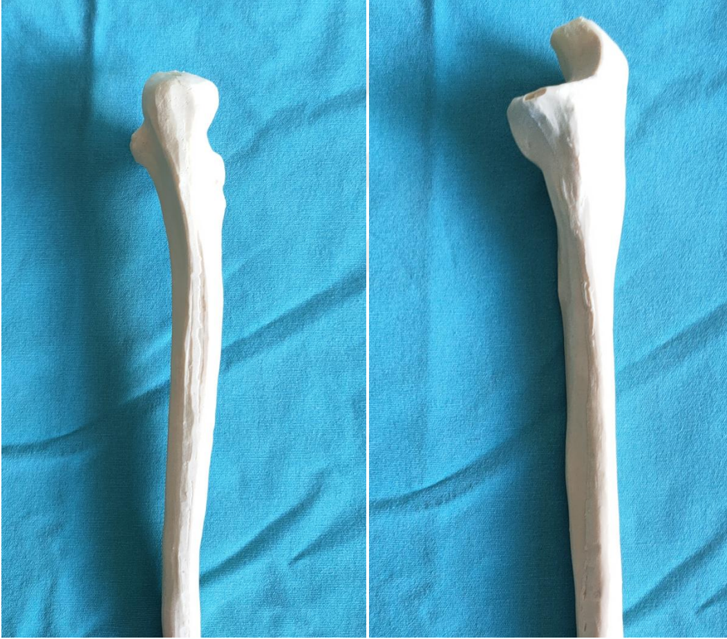
Şekil 4: Deneyde kullanılan ulna kemik modeli (sawbone)
