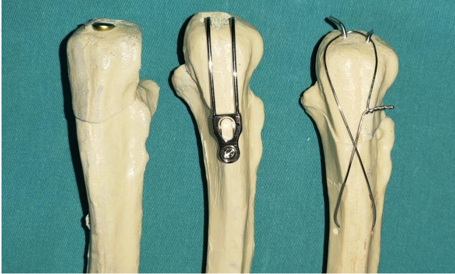
Şekil 13: Vida , hazır gergi bandı implantı ve gergi bandı numunelerin posteriordan görünümü
