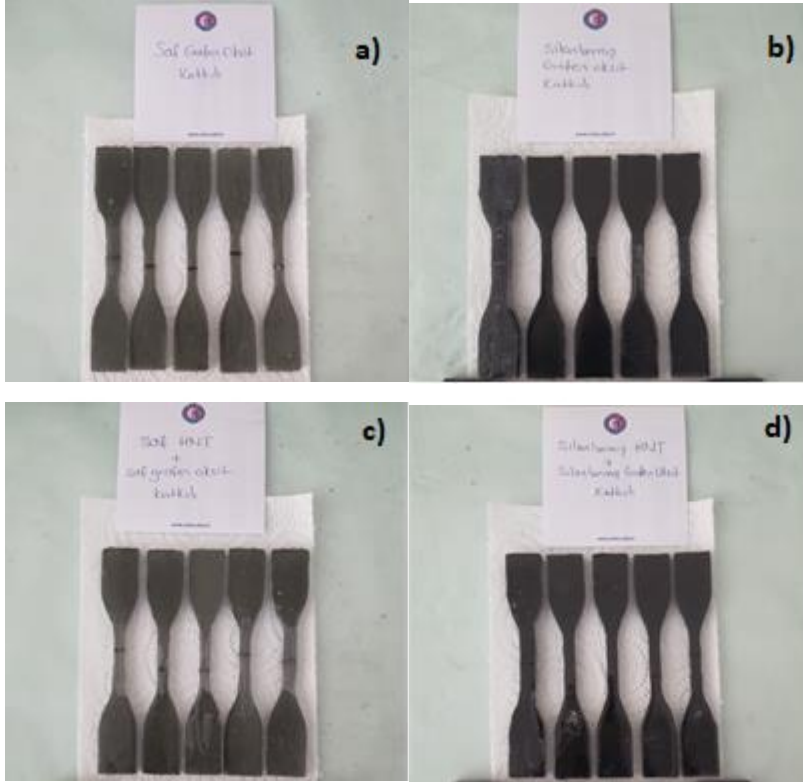
Şekil 15. Hazırlanan enine fiber demeti çekme ve tek eksenli çekme numuneleri a) Saf GO, b) Silanlanmış GO, c) Saf Hibrit numunesi, d) Silanlanmış Hibrit numunesi
