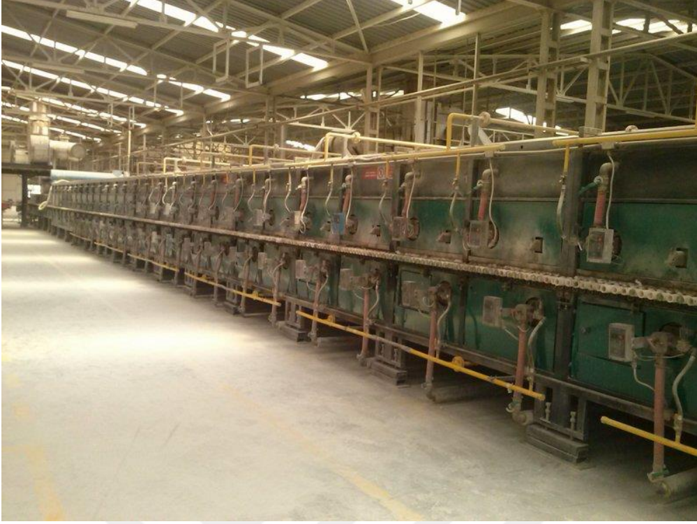
Şekil 1.9. Sürekli üretim yapan rulolu hızlı pişirim fırını
