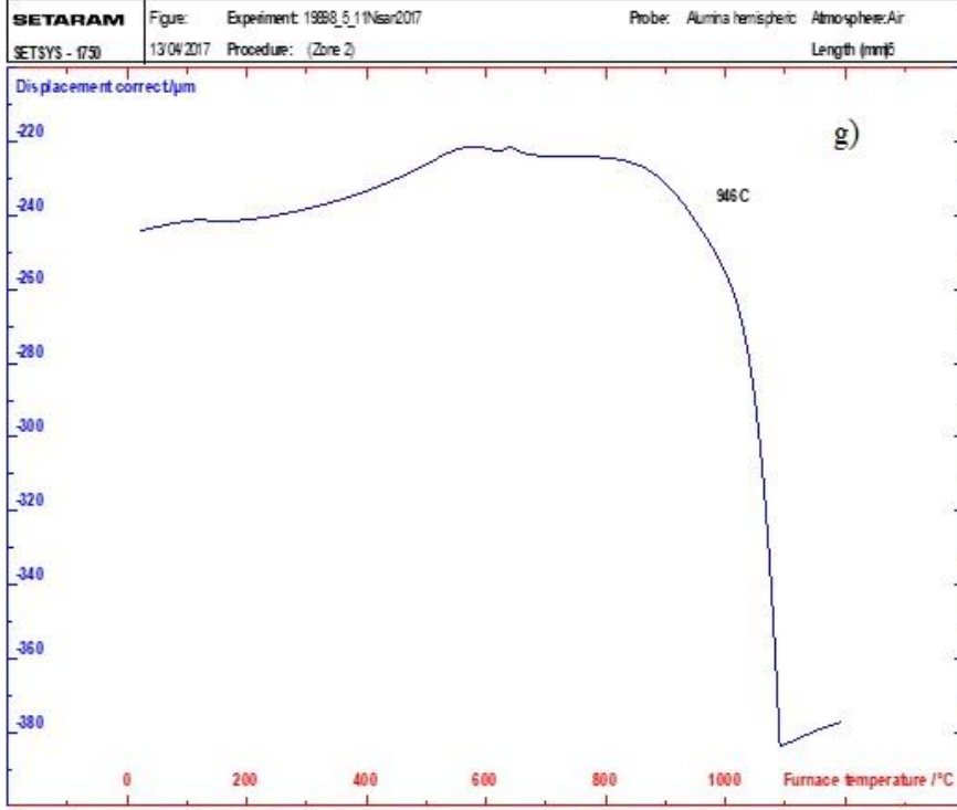
Şekil 4.15. Sağlık gereçleri bünye optik dilatometre grafiği
