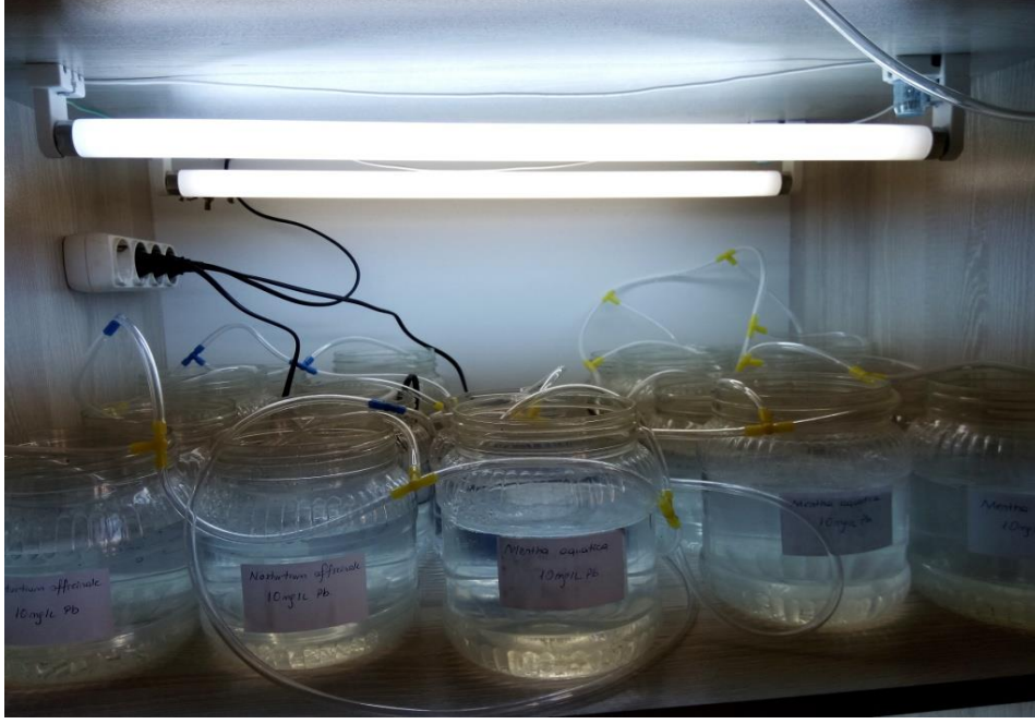
Şekil 3.5: Sucul bitkilerin deney ortamına yerleştirilmeden önce fiziksel şartların sabit olabilmesi için oluşturulmuş olan deney düzeneği
