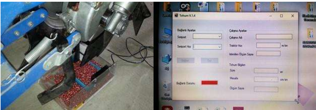
Şekil 5. Sıra üzeri mesafe ölçüm düzeneği(a) ve yazılımı(b)
