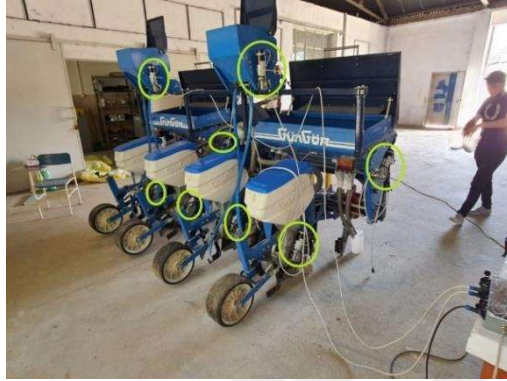
Şekil 6. Atölye testleri hazırlıkları; sistemin montajı (a), ölçüm ve veri toplama sistemleri (b) ve elektrik motorları (c) bağlantıları
