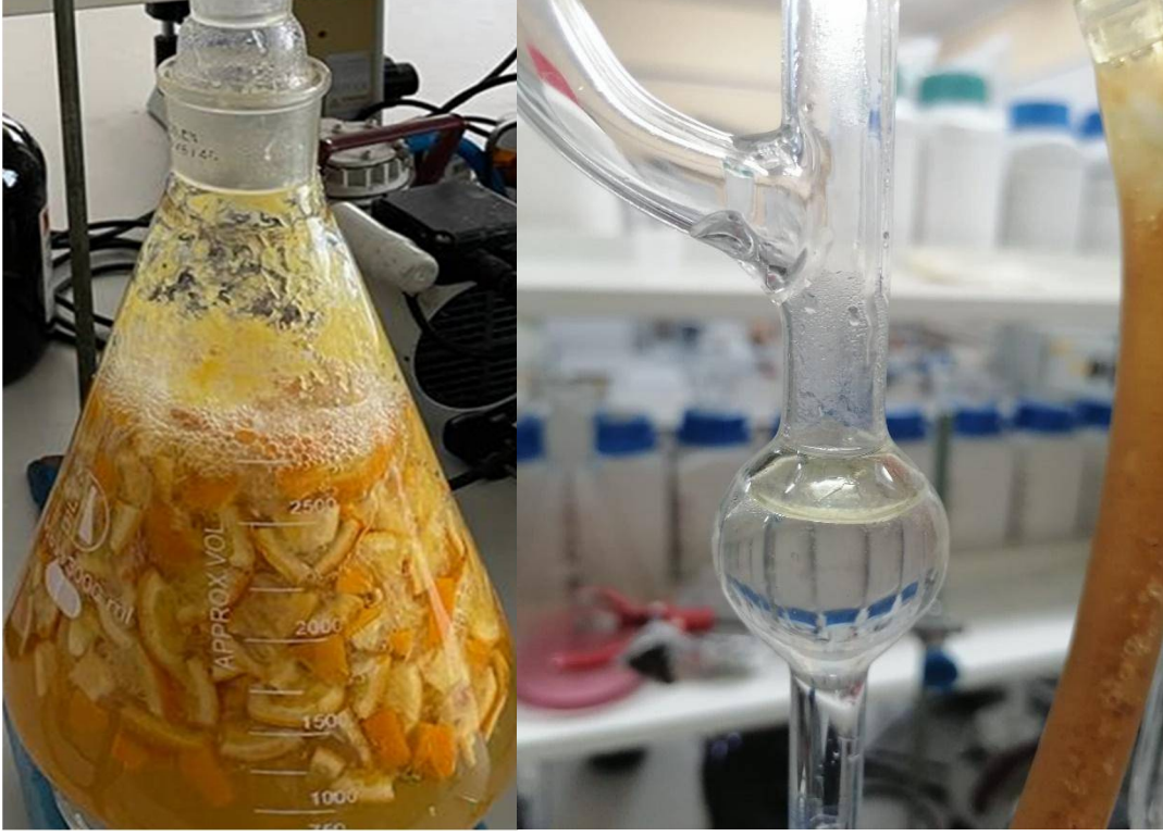
Şekil 5. Portakal kabuğu esans yağının elde edilmesi (Clevenger aparatı).
