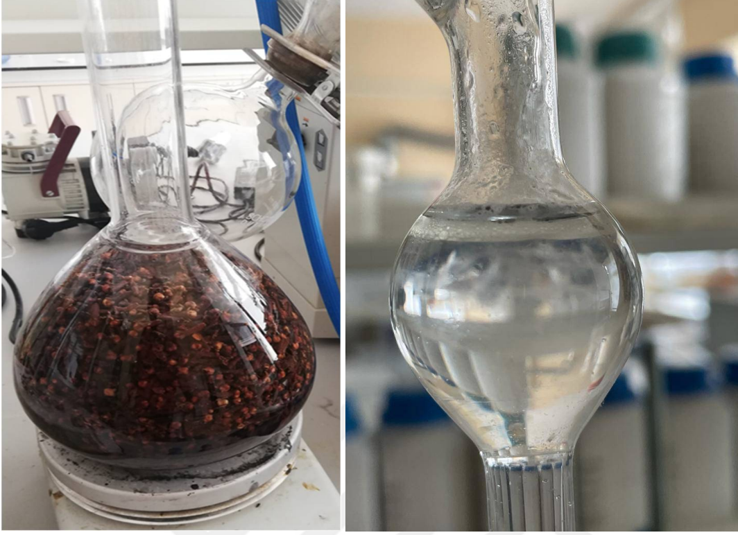
Şekil 6. Karanfil esans yağının elde edilmesi (Clevenger aparatı).
