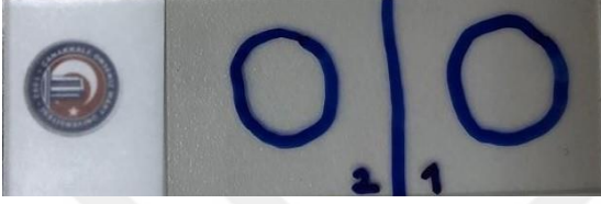
Şekil 60. Bant soyma testi için hazırlanan Ormosil kaplama bölgeleri
