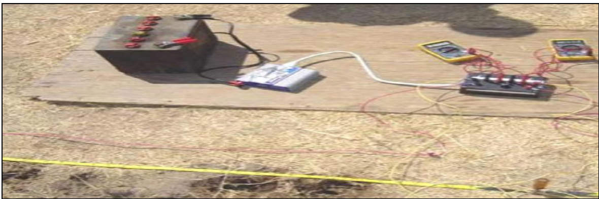
Şekil 7. Clark ve Page (2011) tarafından tasarlanan analog ölçüm aygıtı.
