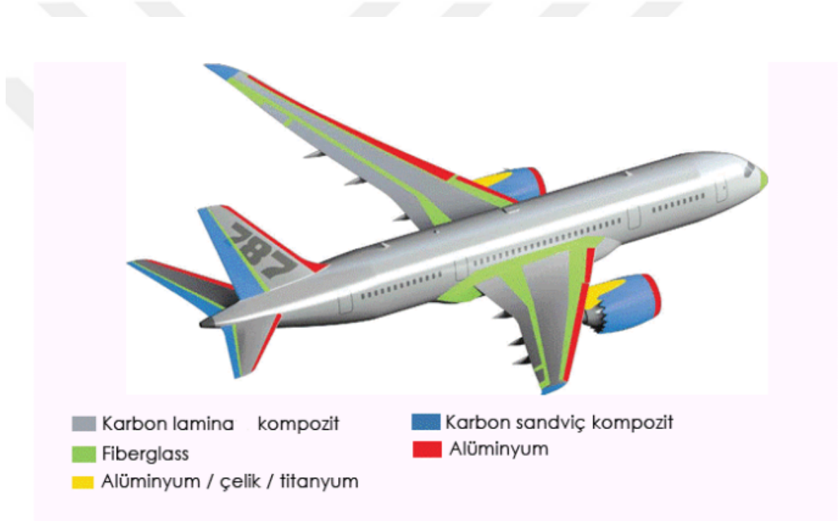
Şekil 8. Boeing 787 Yolcu Uçağının Malzeme Yapısı (Campell, 2010)
