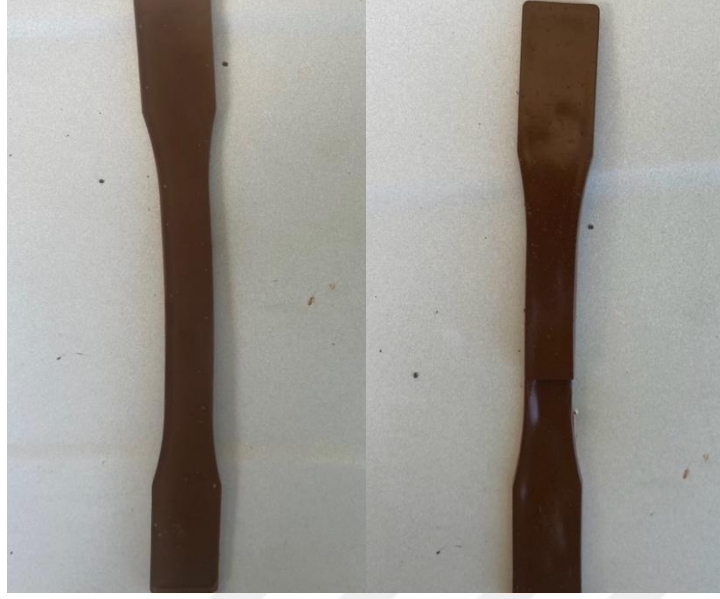
Şekil 29. Biyokompozit Numunelerinin Çekme Testi Öncesi ve Sonrası Görüntüleri
