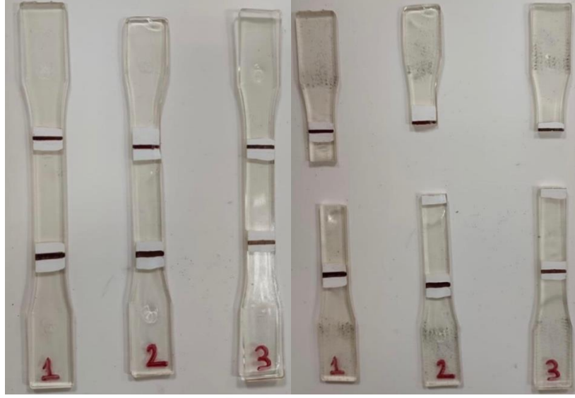
Şekil 28. Saf PLA Numunelerinin Çekme Testi Öncesi ve Sonrası Görüntüleri
