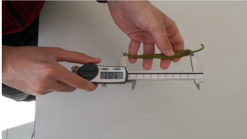
Şekil 4. Dijital kumpas ile meyve boyu ölçümü
