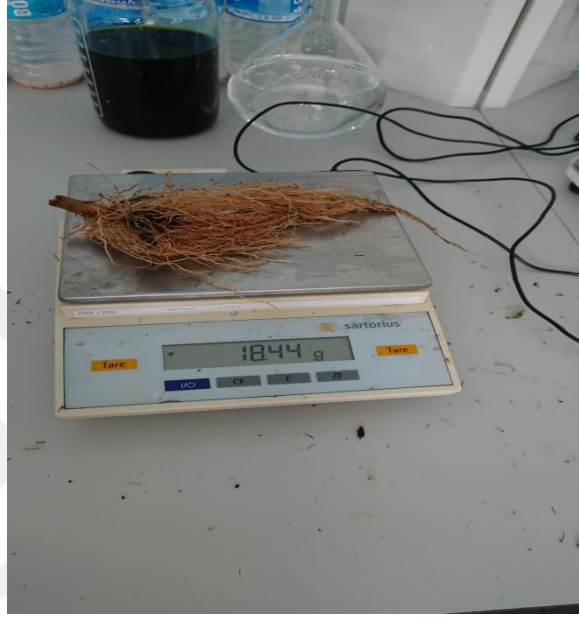
Şekil 11. Hassas terazi ile kök ağırlığının ölçümü
