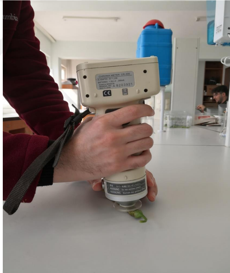
Şekil 7. Kromametre ile meyve rengi ölçümü
