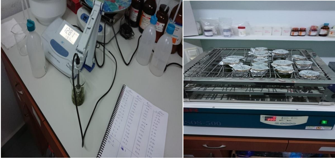
Şekil 9. Membran sızıntısı değeri ölçümü
