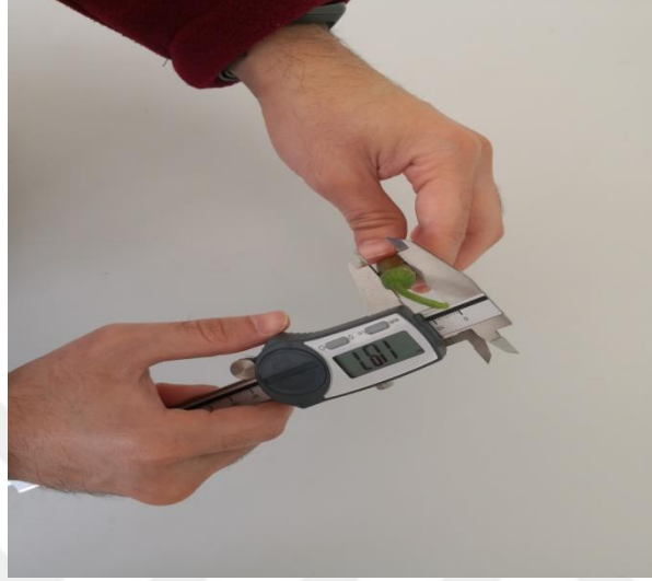
Şekil 5. Dijital kumpas ile meyve eni ölçümü
