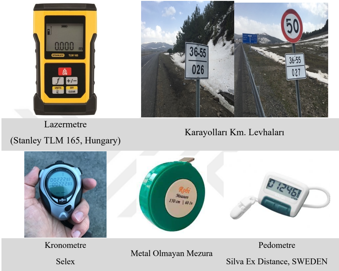
řekil 25. Paten adım uzunluęu ölçümü için kullanılan cihazlar
