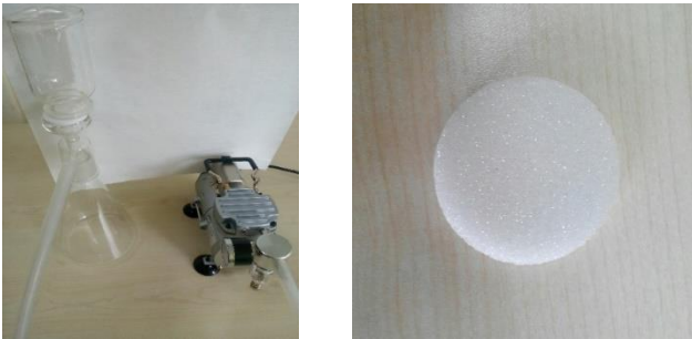
Şekil 3.4. Filtrasyon sistemi ve 100 µm por çapına sahip elek
