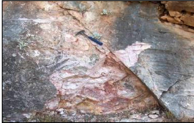
Şekil 4.27. Bej, pembe renkli, laminalı, ince kristalli mermerlerin mostra görünümü (0481264-4384396, fotoğraftaki çekicinin boyu 33 cm dir)
