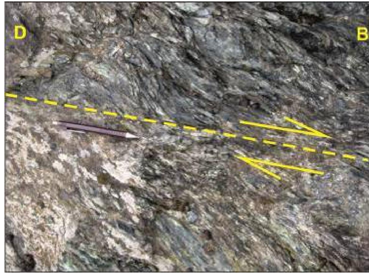
Şekil 4.70. Çetmi grubunun kuzey sınırında yer alan serpantinitletler içerisindeki sağ yönlü doğrultu atımlı fay (UTM Koordinat: 4468775-0510082, fotoğraftaki kalemin boyu 13 cm dir).
