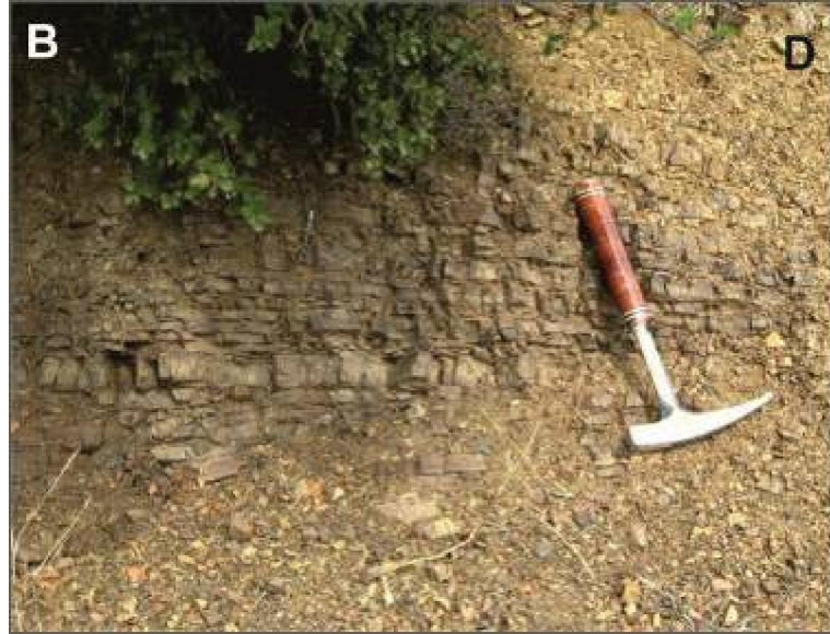
Şekil 4.73. Karapürçek köyünün batısında gözlenen kırmızı renkli, orta tabakalı radyolarit-çörtler (Fotoğraftaki çekicinin boyu 33 cm dir).
