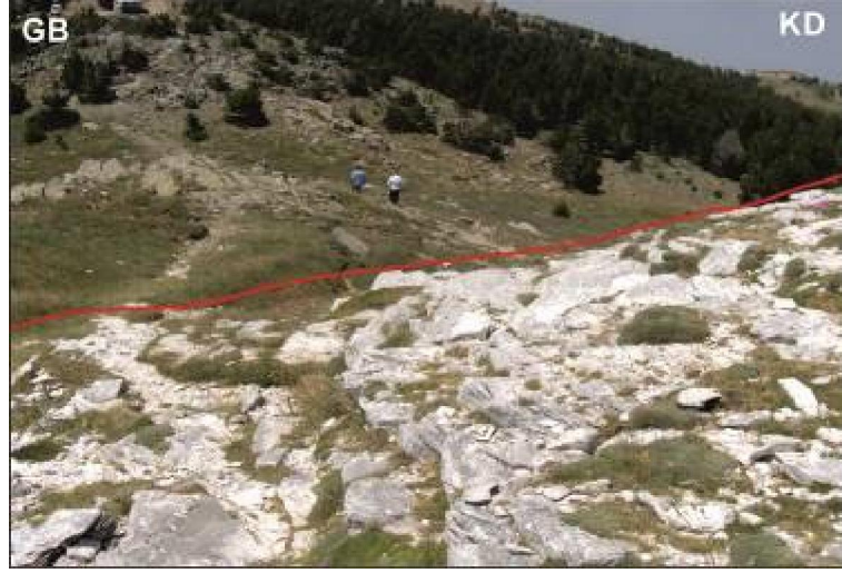
Şekil 4.42. Sarıkız mermeri ile Tozlu metaofiyoliti arasındaki keskin dokanak ilişkisini gösteren fotoğraf (0489120-4393818).
