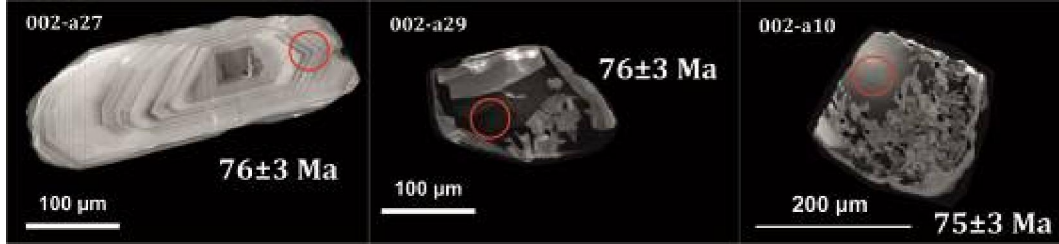
Şekil 4.106. Tozlu metaofiyoline ait metagabrolardan alınan 12-002 No'lu örneğe ait tipik zirkon tanelerinin içyapılarını, örnek numarası, lazer analiz yerini ve numarası ile 2-sigma hata ile milyon yıl (Ma) cinsinden yaşların gösterildiği katodoluminans (CL) görüntüleri
