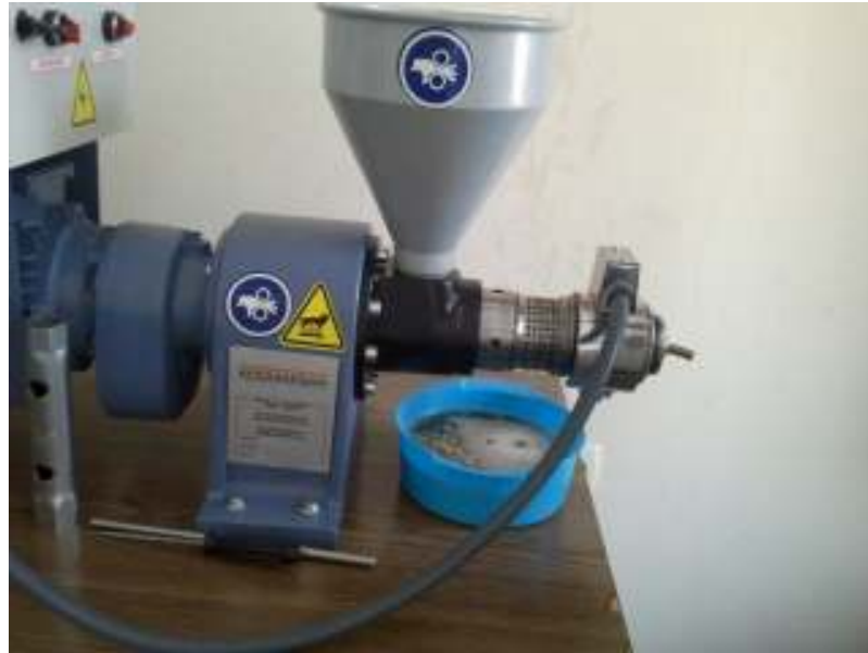
Şekil 3.2. Çalışmada kullanılan laboratuvar tipi soğuk pres makinası
