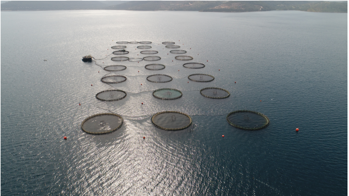
Şekil 47. Açık denizde kurulu, 8x3 grid düzeninde 24 kafesten oluşan ağ kafes tesis görünümü (Barç sistem entegre edilmemiş)
