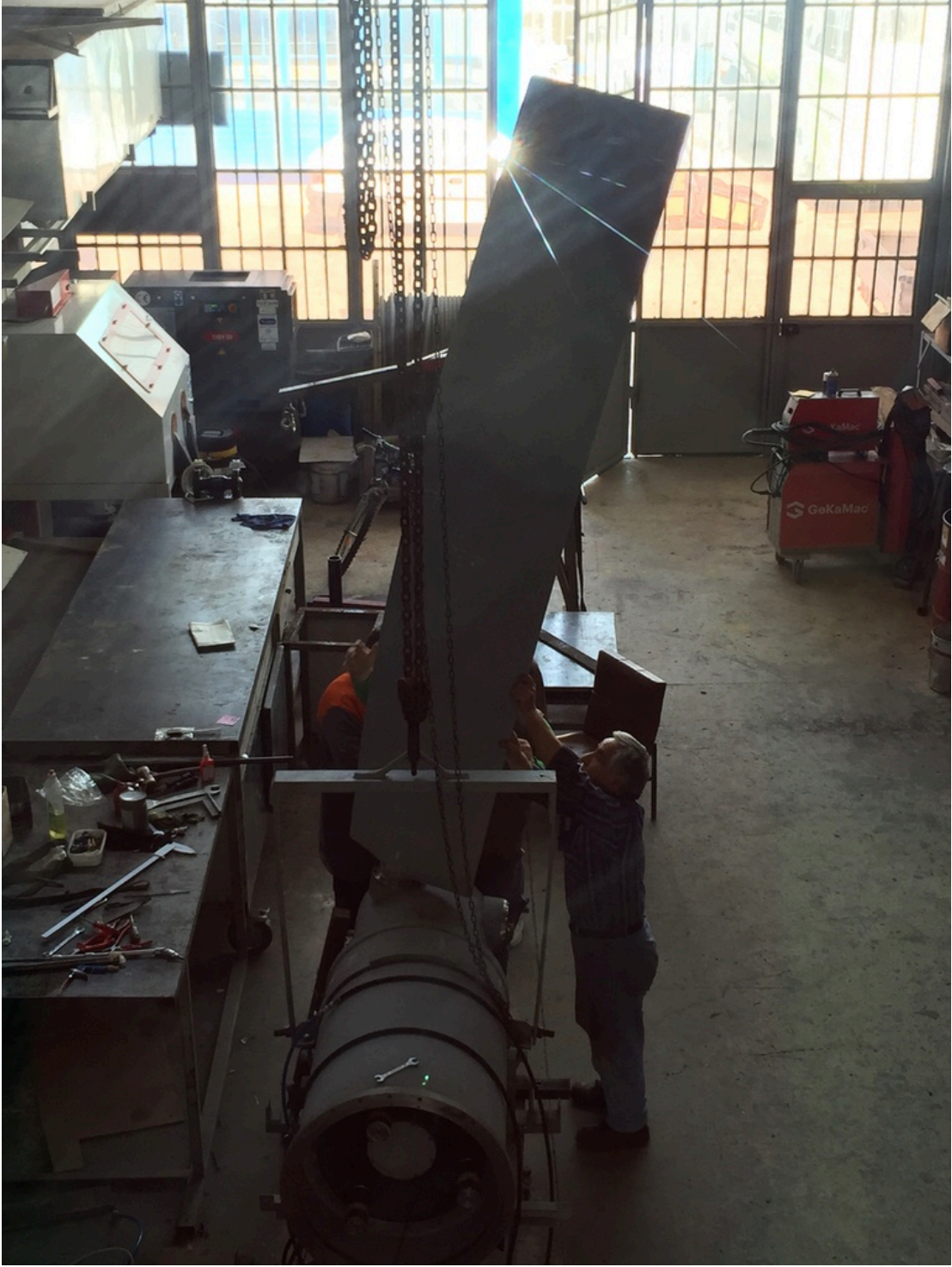
Şekil 67. 55 kW akıntı türbini, Çap 6,4 m (Özgün)
