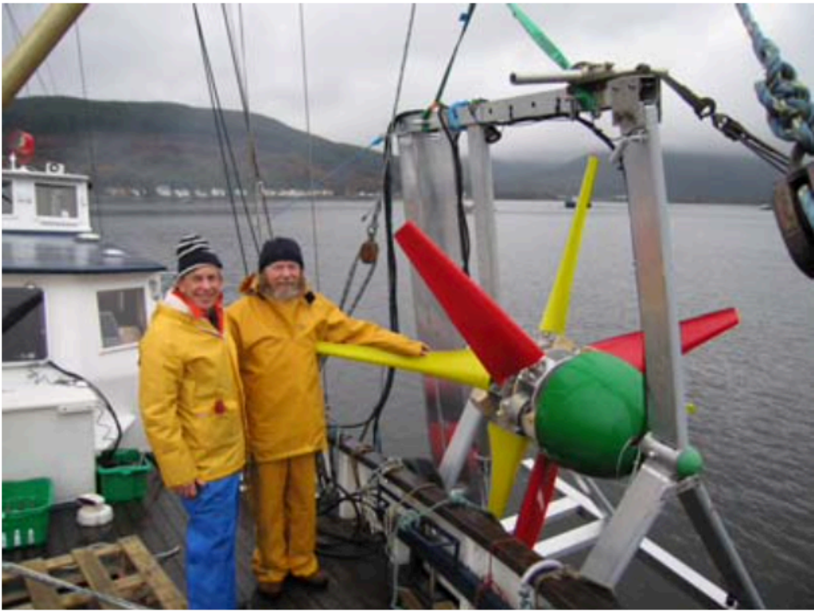
Şekil 65. Strathclyde Üniversitesi'nde geliştirilen 2,5m çapındaki akıntı türbini (Clarke vd., 2006)
