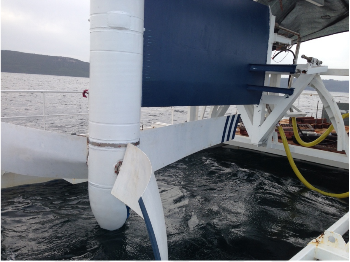
Şekil 35. Türbinin taşıyıcı barç üzerindeki bakım konumu (Özgün)
