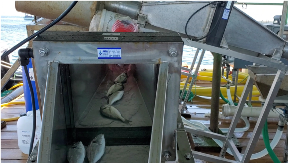
Şekil 57. Balık ayırıcı ve sayıcı sistemler (Akuamaks, Serdar Yıldırım'ın izniyle) (a,b)
