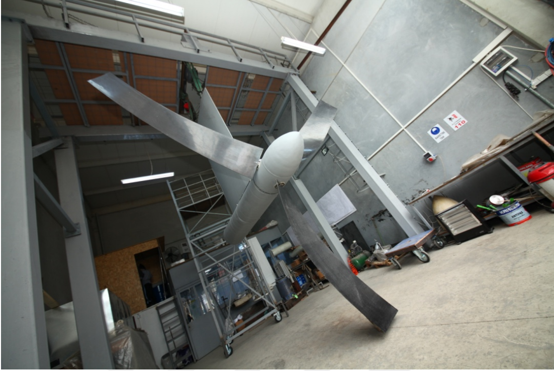
Şekil 29. Karbon fiber olarak üretilen kanatların türbin rotoruna montajı (Özgün)
