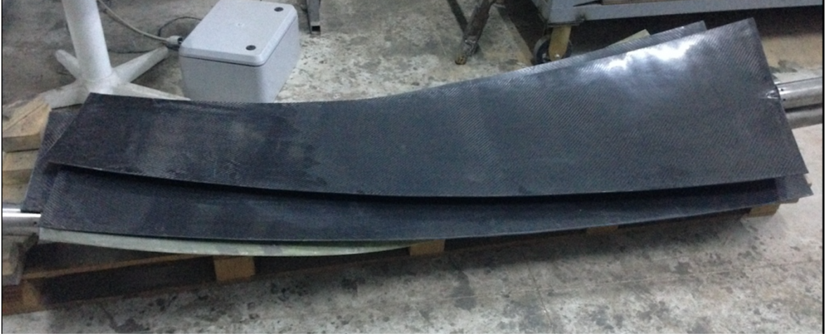
Şekil 26. Karbon fiber türbin kanadı boy 1940mm, genişlik 500mm (Özgün)
