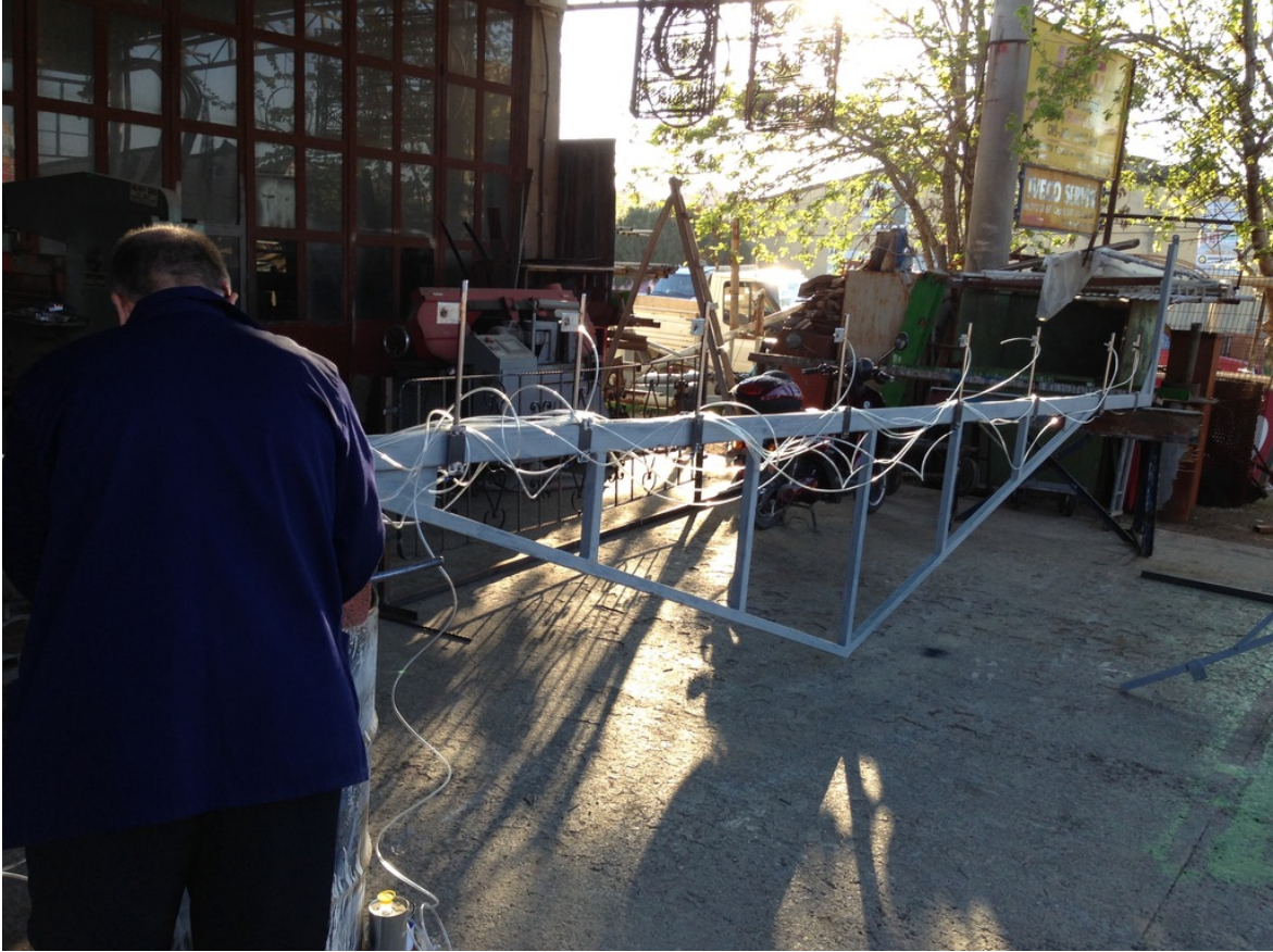
Şekil 18. Farklı derinliklerde akıntı hızı ölçümü için pitot tüplerinin montajı (Özgün)
