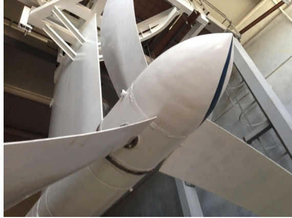
Şekil 7. Geliştirilen 30 kW gücündeki akıntı türbinleri (a,b,c) (Özgün)
