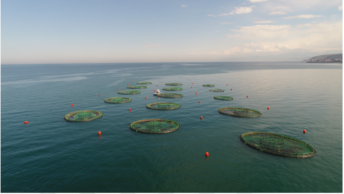
Şekil 46. Açık denizde kurulu, 5x3 grid düzeninde 15 kafesten oluşan ağ kafes tesis görünümü (Barç sistem entegre edilmemiş)
