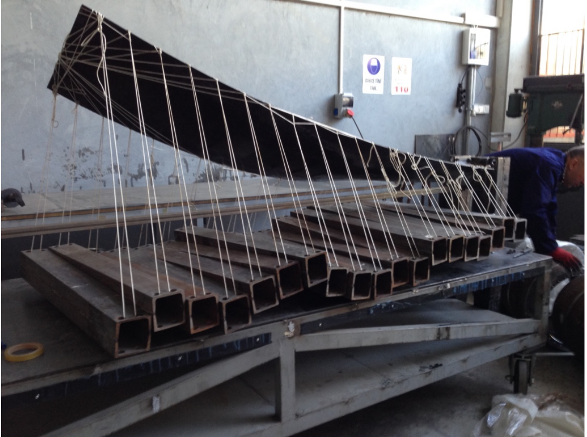
Şekil 27. Karbon fiber türbin kanadı yayılı yük testi (Özgün)
