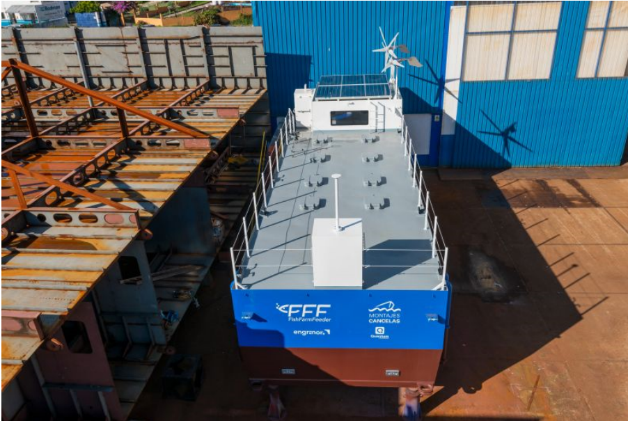
Şekil 54. Barç sistemlerinin elektrik enerjisi ihtiyacını karşılamada katkı sağlayan rüzgar, güneş, rüzgar & güneş beraber hibrit modeller (Akuamaks, Serdar Yıldırım'ın izniyle) (a,b,c)
