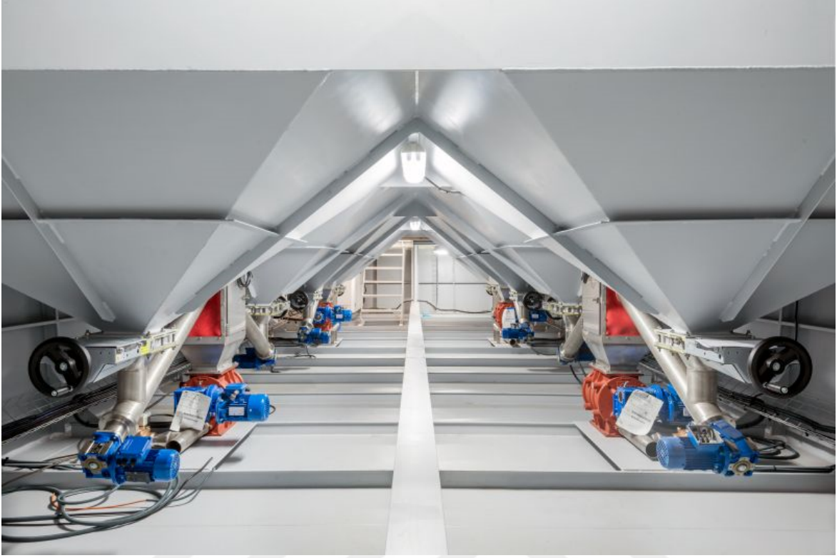
Şekil 55. Barç yemleme depoları ve pompa ünitesi (Akuamaks, Serdar Yıldırım'ın izniyle)
