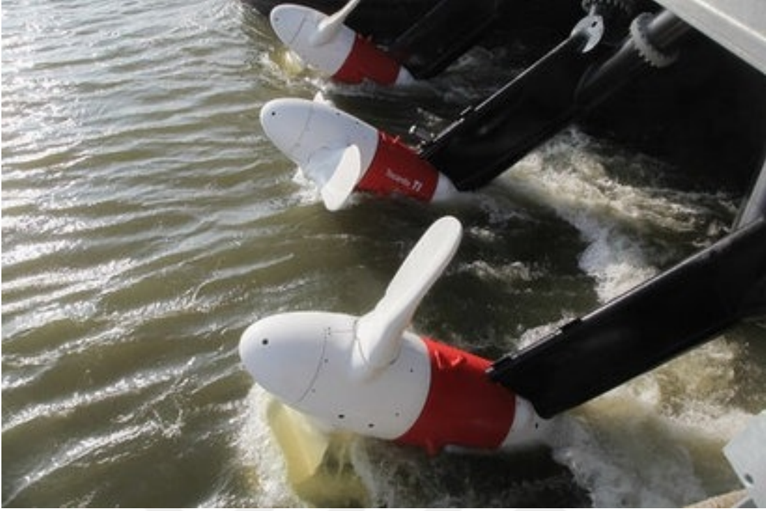
Şekil 4. Tocado BV firmasının Eastern Scheldt, Hollanda’da kurulu 5 adet türbini sistemi (Whitlock, 2015).
