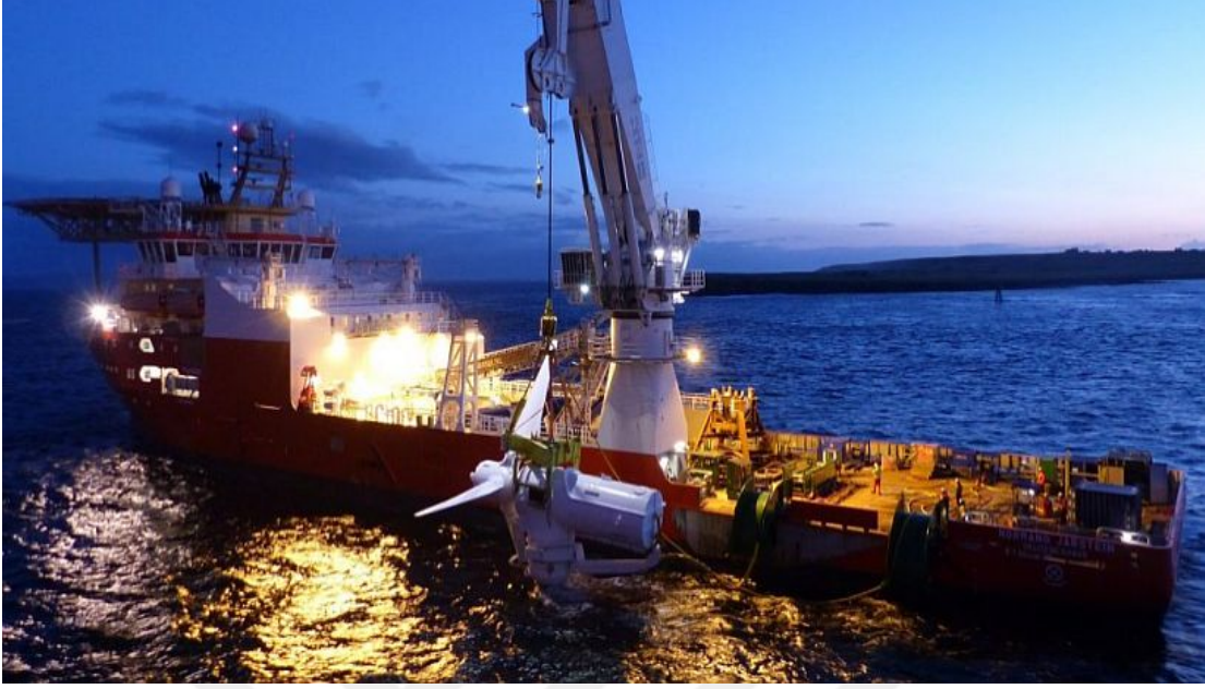
Şekil 6. Simec Atlantis firmasının 2MW gücündeki hali hazırda dünyanın en büyük akıntı türbini İskoçya, 2019 (Oram, 2019).
