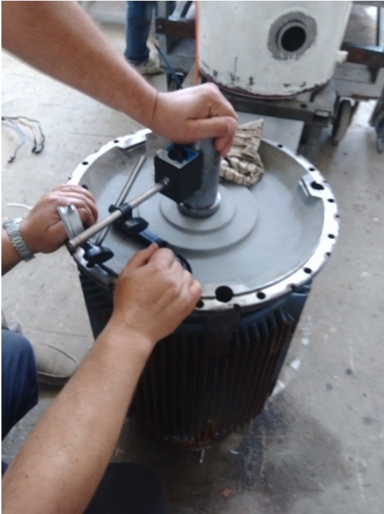
Şekil 33. Türbinin alternatörü AC 30kW gücünde (Özgün)
