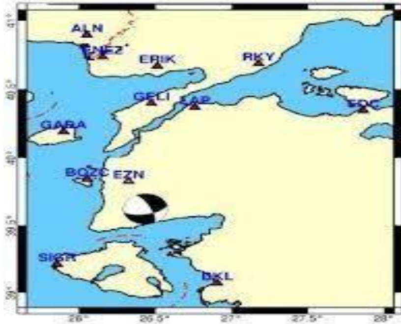
Şekil 7. Depremin fay düzlemi çözümü (B.Ü., 2019)
