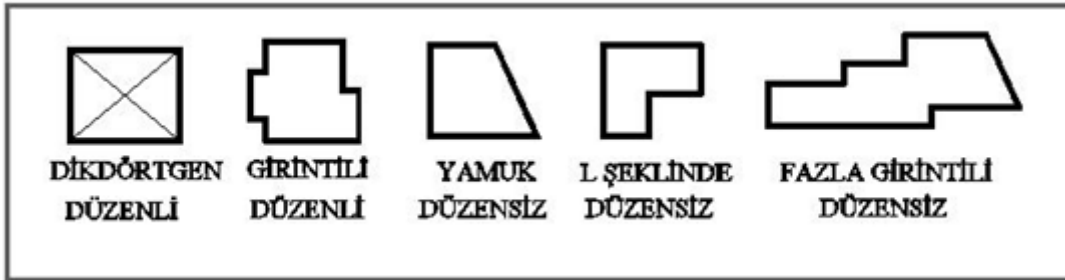
Şekil 15. Planda düzensizlik durumu (RYTEİE, 2019)
