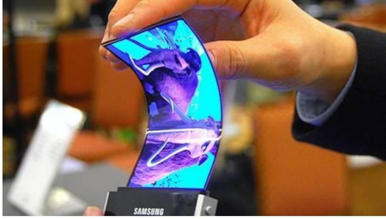
Şekil 7. Konjuge polimerler kullanılarak Samsung tarafından hazırlanan prototip esnek ekran (Lajoie, 2015).
