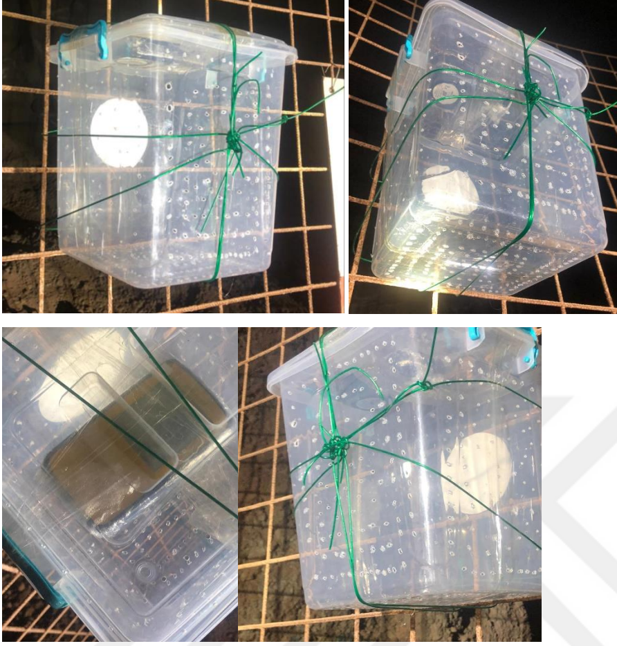
Şekil 4. Radon gazı dedektörünün madenlerde ölçüm muhafaza, koruma ve ölçüm yeri
