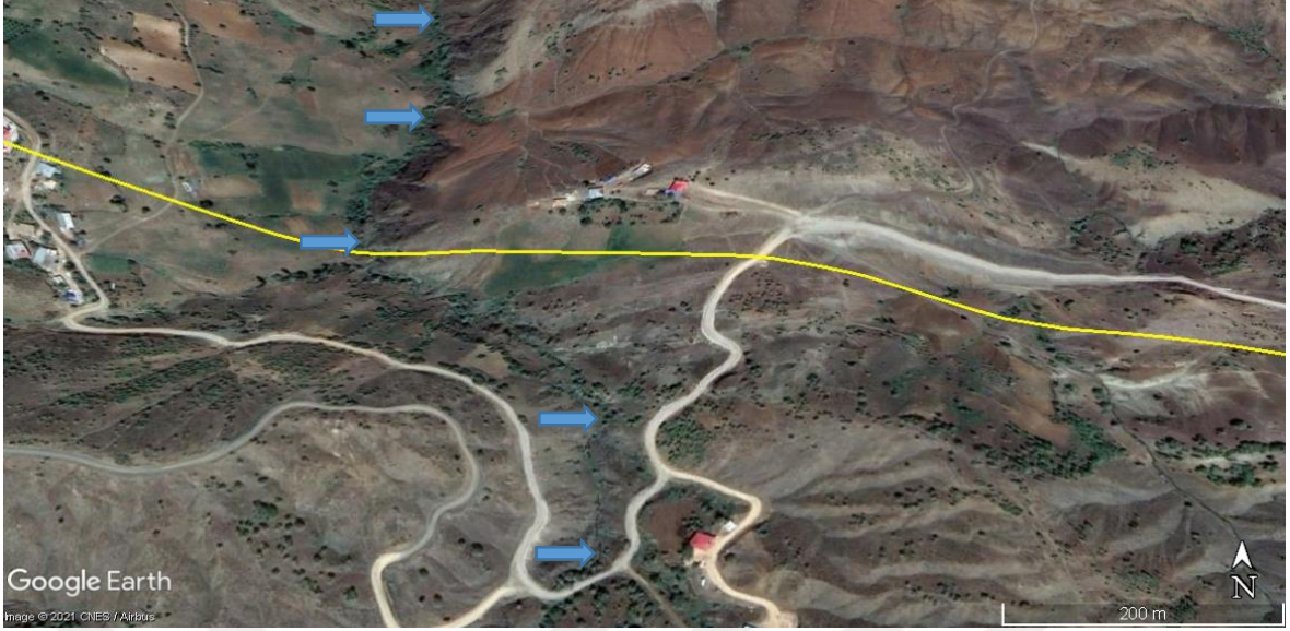
Şekil 40. Karadut'un GD'sundaki dere yatağının Çardak Fayı tarafından ötelenmesinin GE görüntüsü. Sarı çizgi Çardak Fayı güzegahını, mavi oklar 280 m ötelenmiş dere yatağını göstermektedir.
