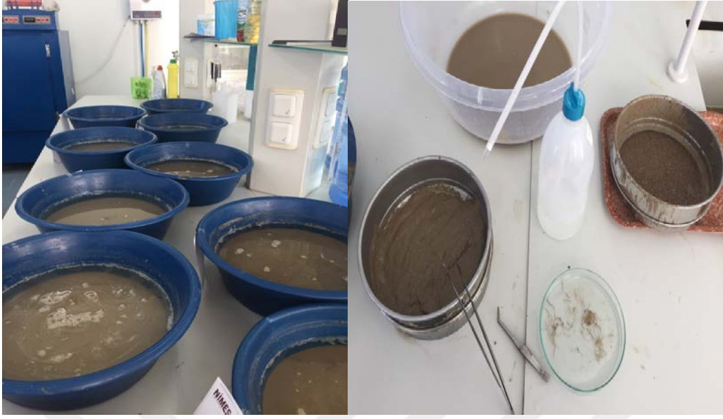
Şekil 12. Bozulmamış toprak örneklerinin yıkanması
