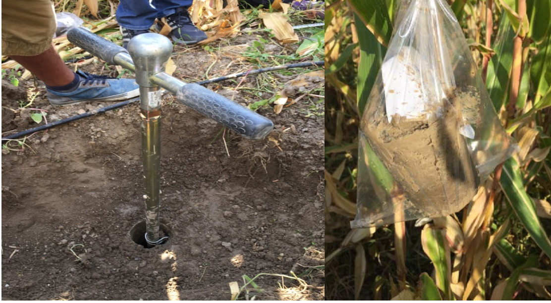
řekil 11. İki paralı kk burgusu ile bozulmamıř toprak rneklерinin alınması
