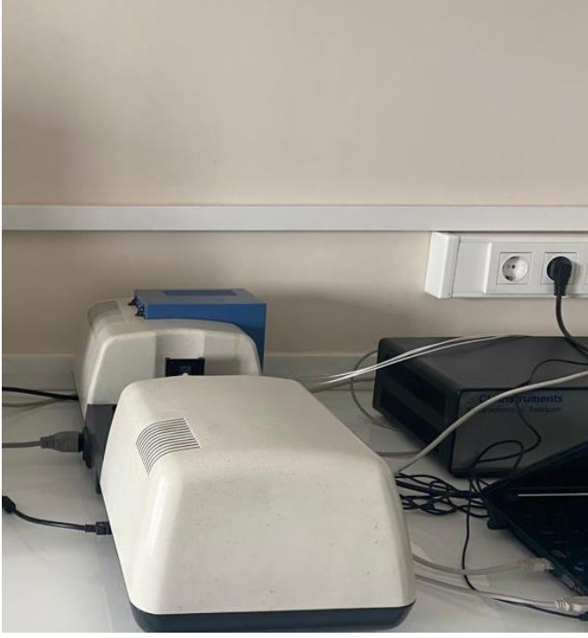
Şekil 24. Specord S 600 marka UV-Vis cihazı
