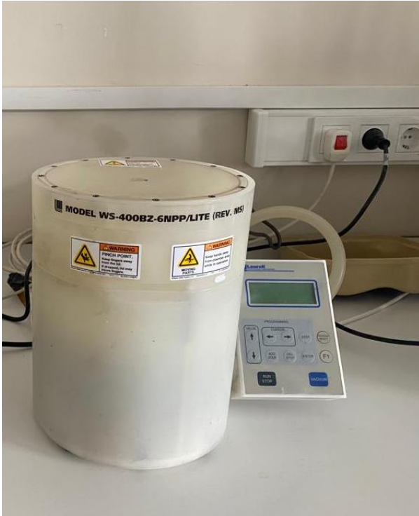
Şekil 27. Laurell WS-400BZ-6NPP/LİTE döndürme ile kaplama cihazı
