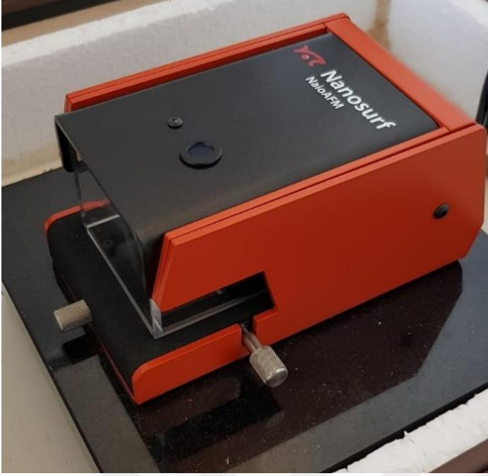
Şekil 29. Atomik kuvvet mikroskobu
