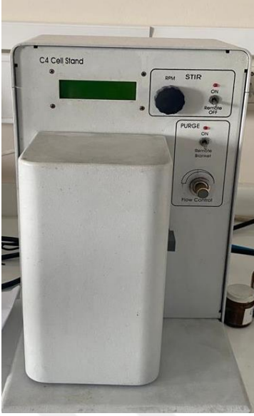
Şekil 25. CH Instrument marka 617E model elektrokimyasal hücre
