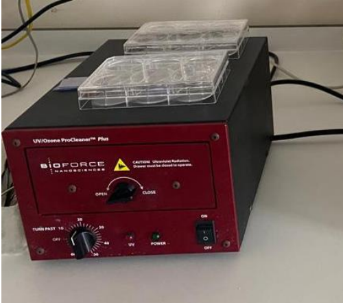
Şekil 26. Bioforce Uv-Ozon procleaner
