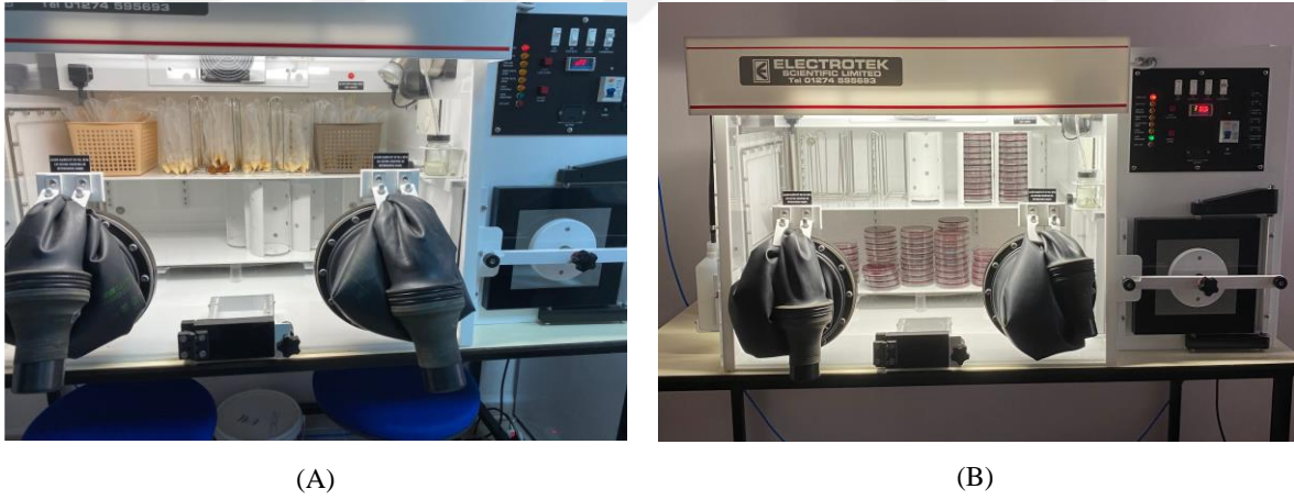
Şekil 6. Süt ve peynir örneklerinde C. difficile aranmasında inkübasyon görüntüleri (A) Ön zenginleştirme (B) selektif besiyerinde anaerobik inkübasyon
