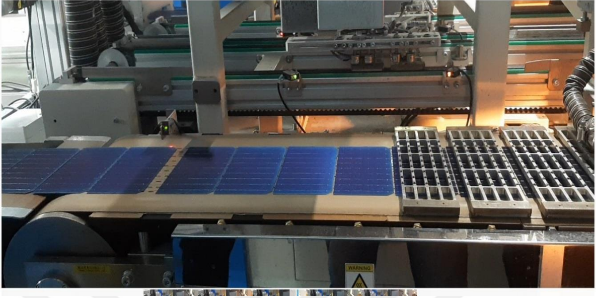
Şekil 12. Fotovoltaik modüllerin robotik makinelerde birleştirilmesi
