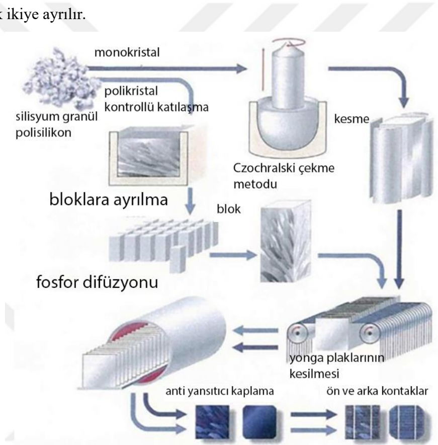
Şekil 15. Silisyum hammaddesinden fotovoltaik hücre yapım aşamaları (Girgin, 2011)
