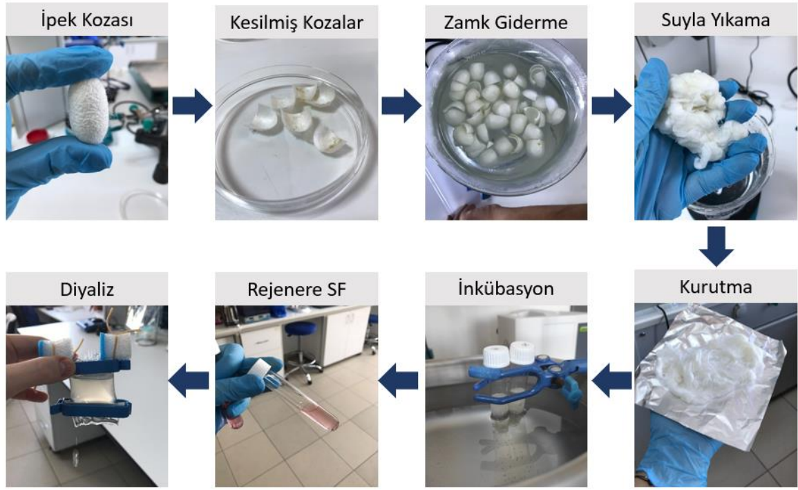
Şekil 9. İpek kozalarından rejenere ipek fibroini çözeltisi eldesi
