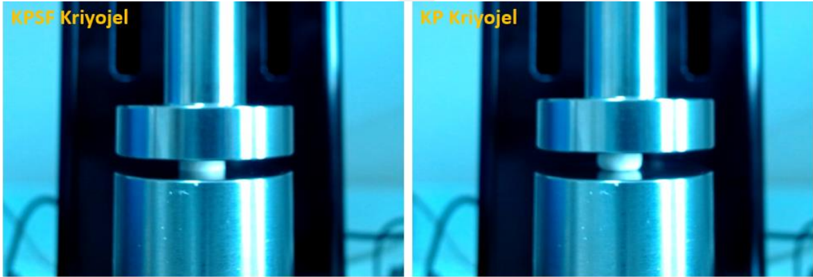
Şekil 13. KP ve KPSF kriyojellerin basma testi sırasındaki görüntüleri
