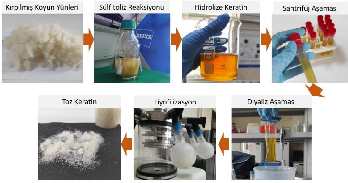
Şekil 8. Koyun yünlerinden keratin ekstraksiyonu işleminin genel şeması
