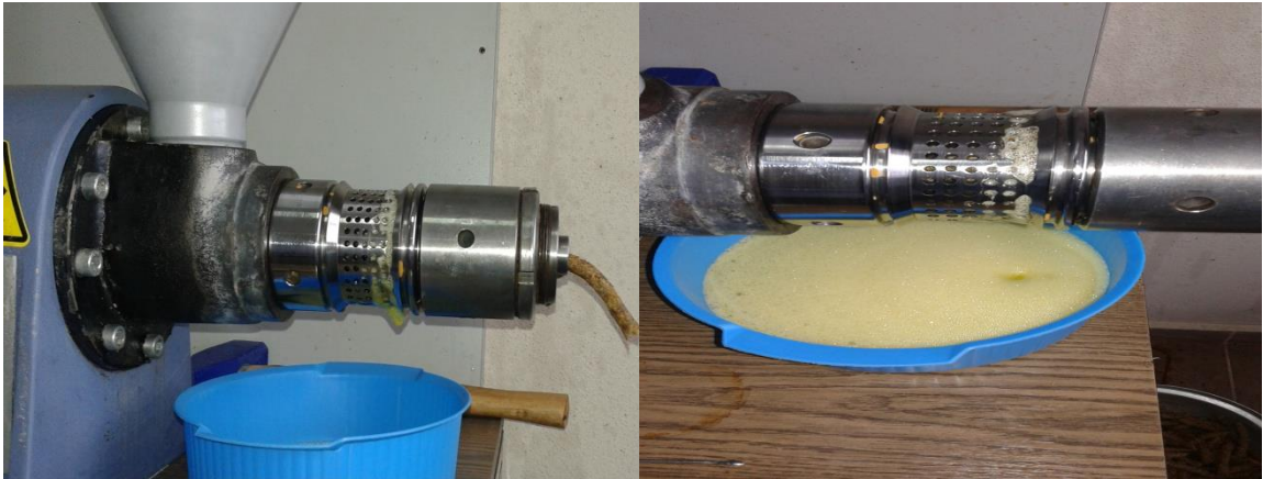
Şekil 3.4. Narenciye çekirdek yağlarının eldesinde kullanılan laboratuvar ölçekli soğuk pres makinası
