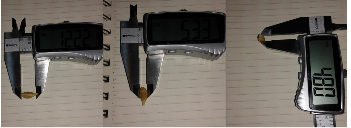
Şekil 3.1. Dijital kumpas yardımıyla narenciye çekirdeklerinde gerçekleştirilen uzunluk, genişlik ve kalınlık ölçümleri
