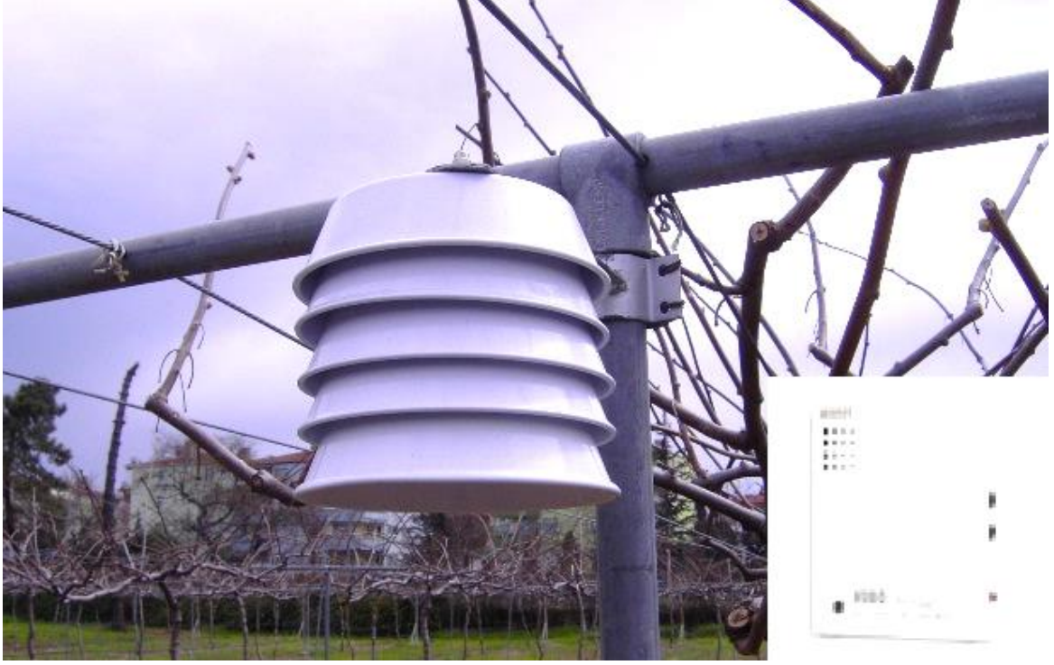
Şekil 8. Tozlanma ve keseleme denemelerinin kurulduğu parsele yerleştirilen veri kaydedici cihaz ve rasat siperi (orijinal).
