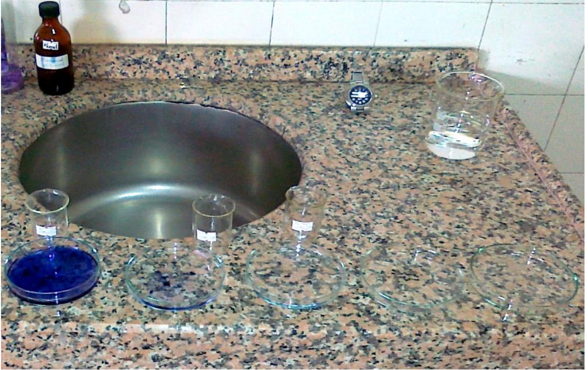
Şekil 40. Lakmoid boyama sonrasında örneklerin saf su ile yıkanması işleminden bir görünüm (orijinal).
