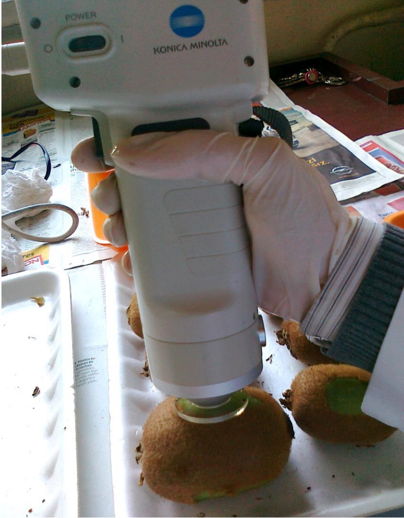
Şekil 62. Üst yeşil meyve etinde Minolta cihazı ile renk ölçümünden bir görünüm (orijinal).
