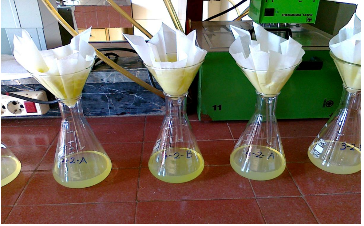
Şekil 64. C vitamini ölçümleri için numuneleri oksalik asit ile filtre kağıdından süzme işleminin görünümü (orijinal).
