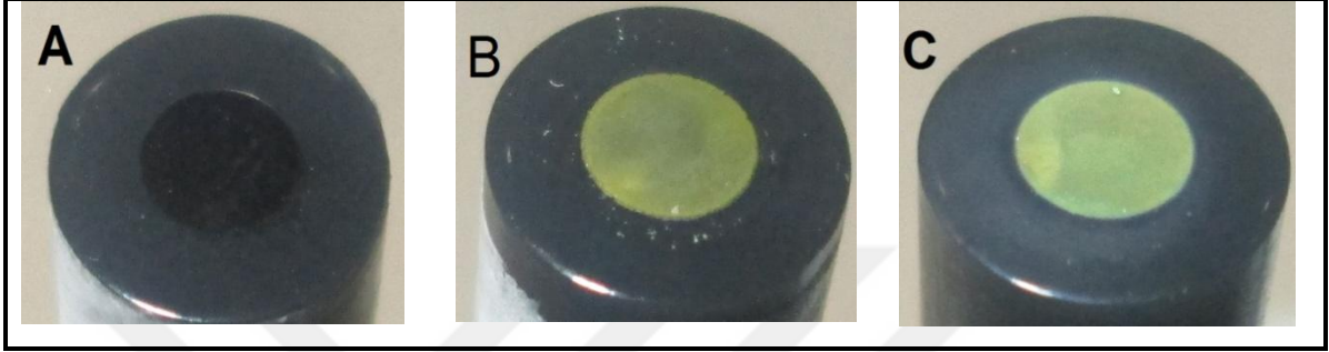
Şekil 4.11. A) Yalın GCE, B) GCE/CdS, C) GCE/CdS-MAA'nın fotoğrafları
