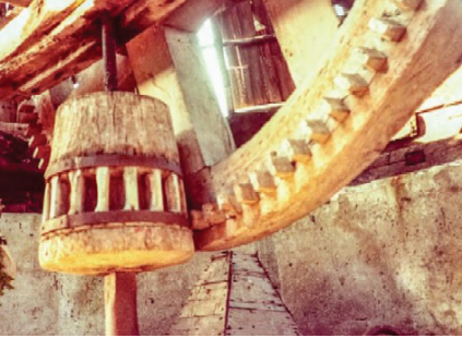
Res. 26: Değirmenin ahşap çalışma mekanizması ( http://ekinlik.org ).
