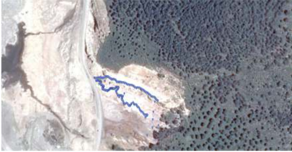
Şekil 32. RTK-GPS tekniği ile ölçülen detay noktaları.
