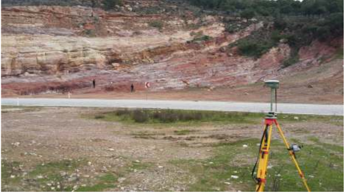
Şekil 30. Termal alanda sabit ve gezici RTK-GPS ölçmeleri.
