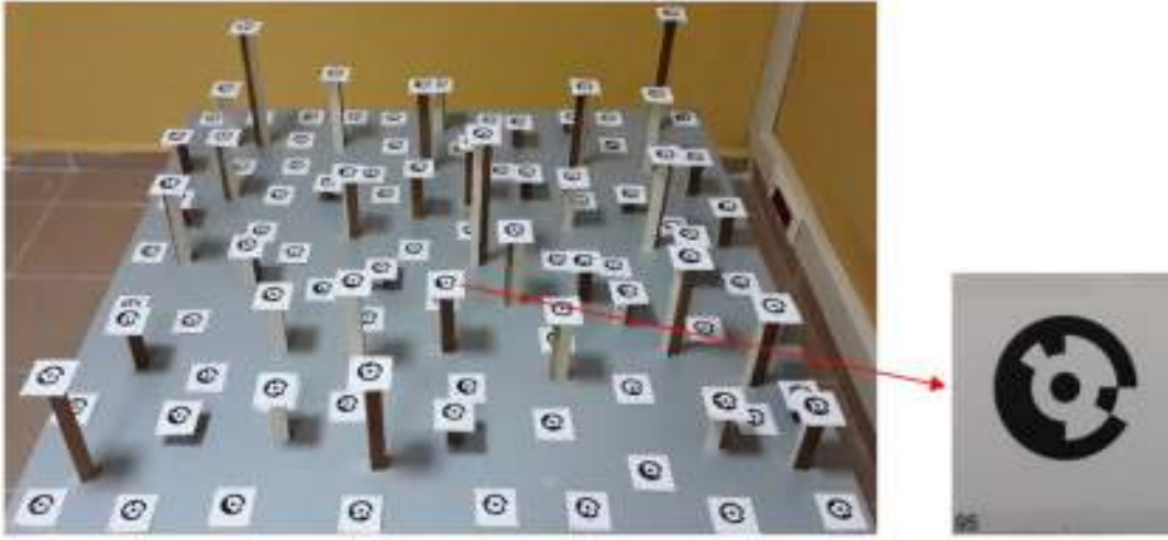
Şekil 6. Özel hedeflerden oluşan kalibrasyon test alanı
