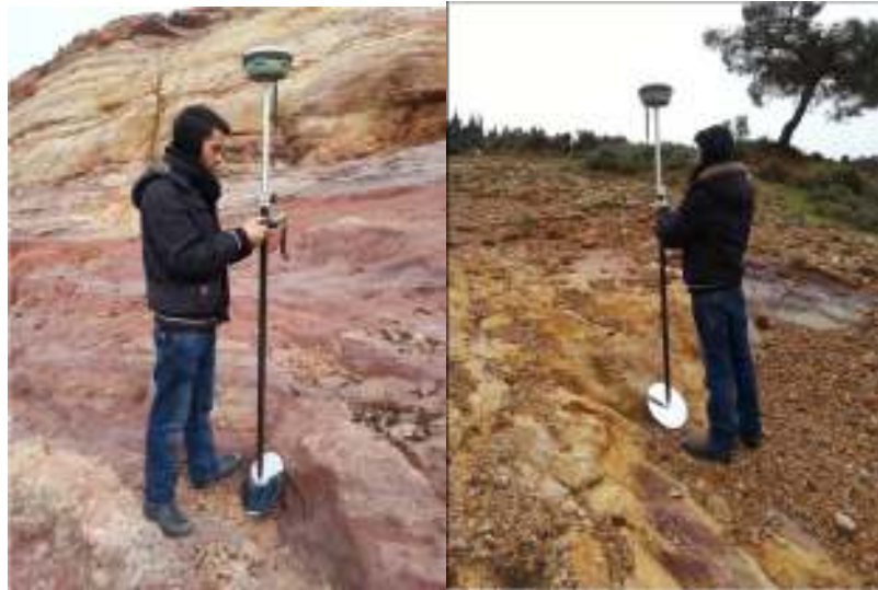
Şekil 31. Özel yansıtıcı hedeflerde gerçekleştirilen RTK ölçmeleri.
