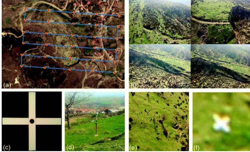
Şekil 80. (a) Ambaroba heyelanı için elde edilen uçuş planı, (b) İHA ile toplanan hava fotoğraflarından birkaç örnek, (c) (+) şeklindeki yer kontrol noktası ölçüm işareti, (d) Yer kontrol noktalarındaki RTK/GNSS ölçmeleri, (e) Yer kontrol noktalarının zemindeki görünümü, (f) Yer kontrol noktalarının fotoğraftaki görünümü.
