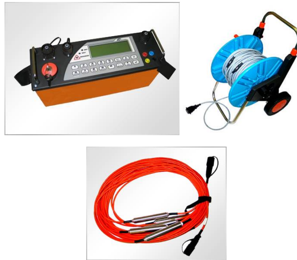
Şekil 53. ARES ölçü aleti kontrol birimi ve donanımı ( www.gfinstruments.cz )
