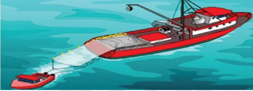
Şekil 5. Yardımcı bot ile gırgır aġının serilmesi (Tantoġlu, 2016)
