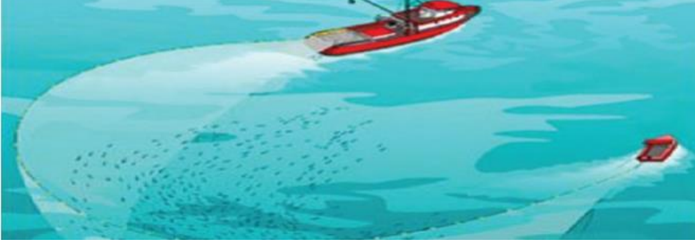
Şekil 6. Gırgır aġının serilerek balıġın çevrilmesi (Tantoġlu, 2016)
