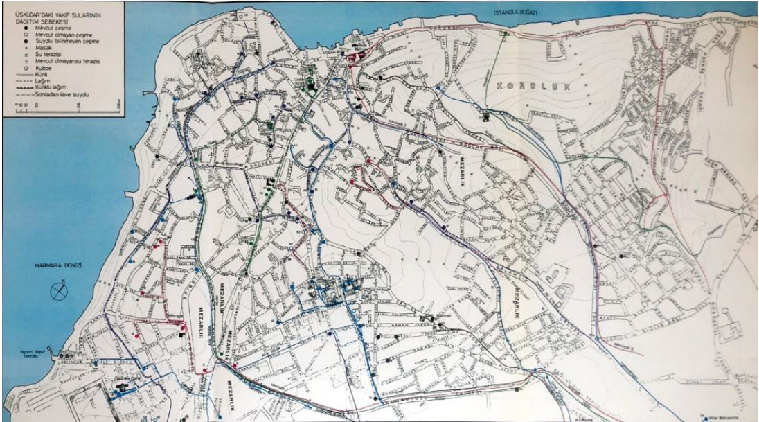
Resim 49: Üsküdar Su Dağıtım Şebekesi (Çeçen, 1999).
