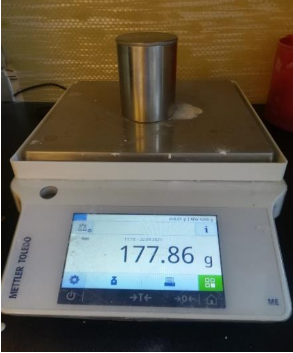
Şekil 4. Piknometre ile sıvı yoğunluğunun ölçümü
