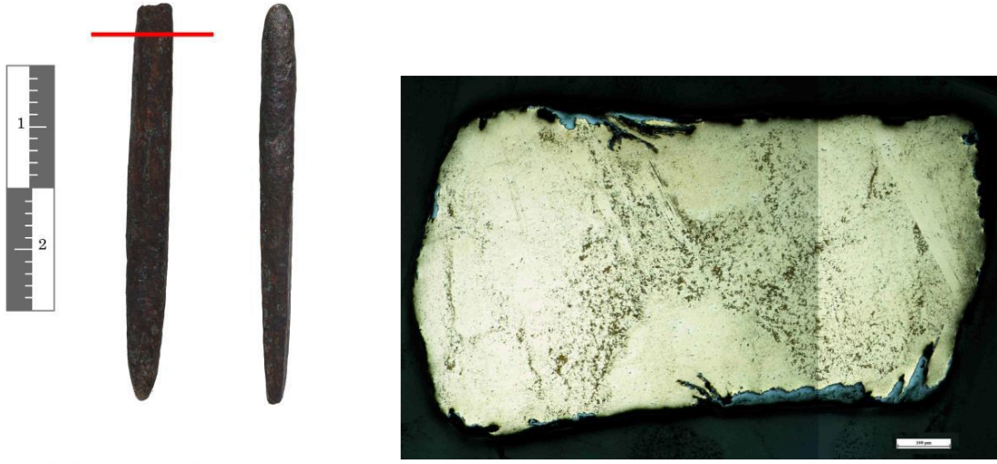
Şekil 8. Bız üzerinden numune alımı ve numunenin dağlamadan önceki mikroskop görüntüsü
