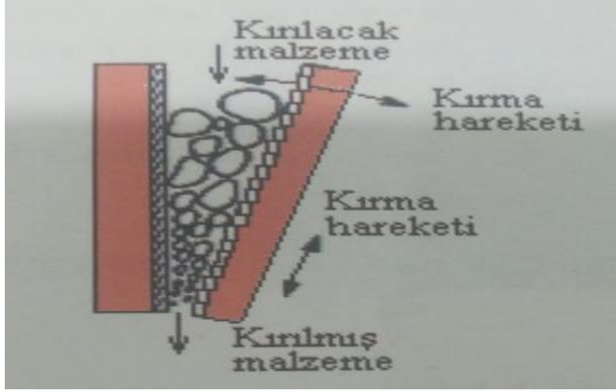
Şekil 21. Çeneli kırıcının kırma hareketi (Yıldız, 2010)
