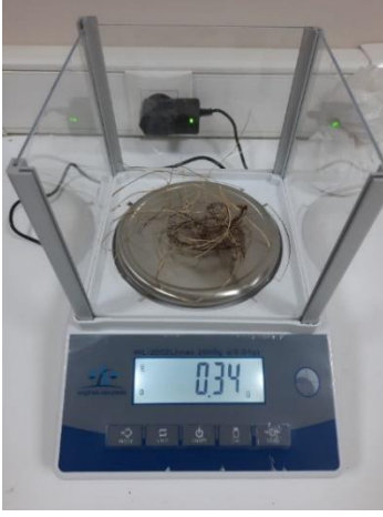
Şekil 17. Buğday kuru ağırlığının ölçümü
