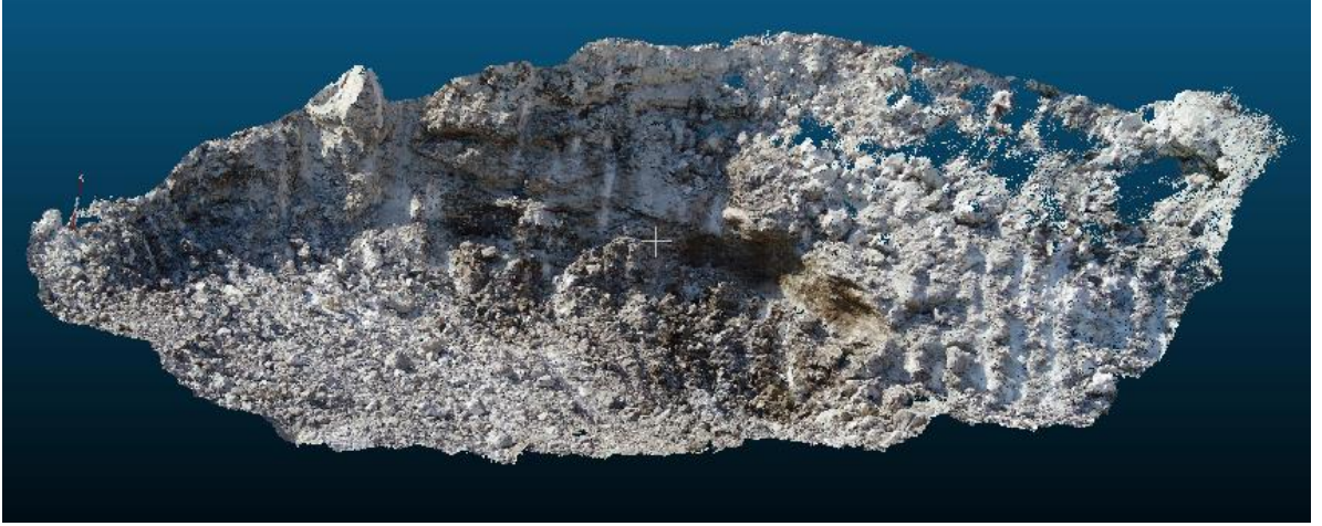
Şekil 13. A) Hacim hesabında kullanılan bor bölgesindeki kazı öncesi yoğun nokta bulutu B) Hacim hesabında kullanılan bor bölgesindeki kazı sonrası yoğun nokta bulutu
