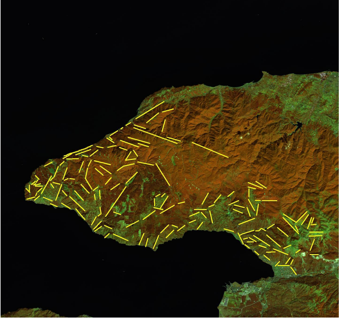
Şekil 10. Armutlu Orhangazi arasında yer alan, band kombinasyonu ve görüntü keskinleştirme işlemi uygulanarak elde edilmiş görüntü üzerine çizilmiş çizgisellikler.
