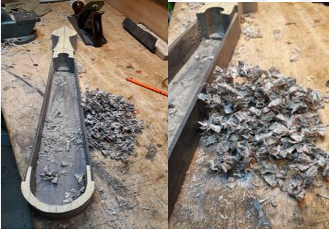
Şekil 34. Enstrümanın, gereken ölçüler halinde şekillendirilmesi (Fotoğraf Ceyhun Demir, 2022).
