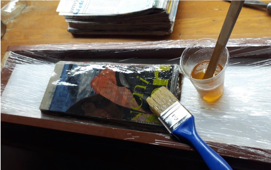
Şekil 29. Epoksi reçinenin katman aralarına uygulanması (Fotoğraf Ceyhun Demir, 2022).
