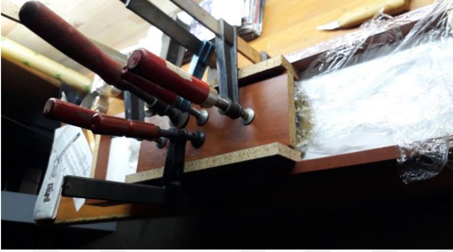
Şekil 30. Hazırlanan kalıp içerisinde presleme uygulaması (Fotoğraf Ceyhun Demir, 2022).
