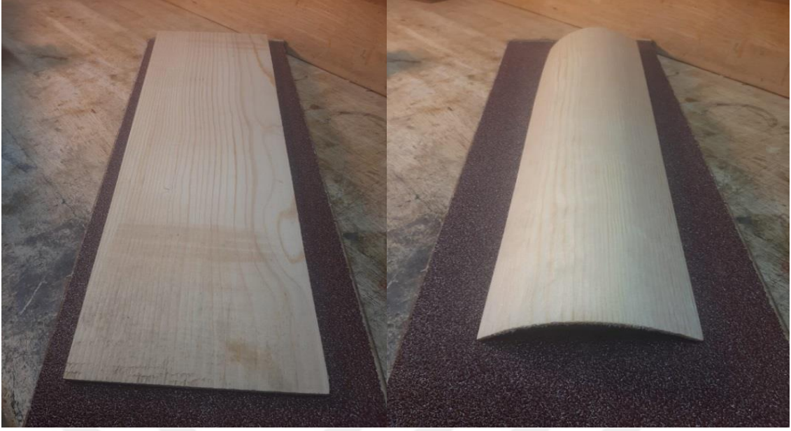
Şekil 19. Kapak şeklinin verilmesi (Fotoğraf Ceyhun Demir, 2022).
