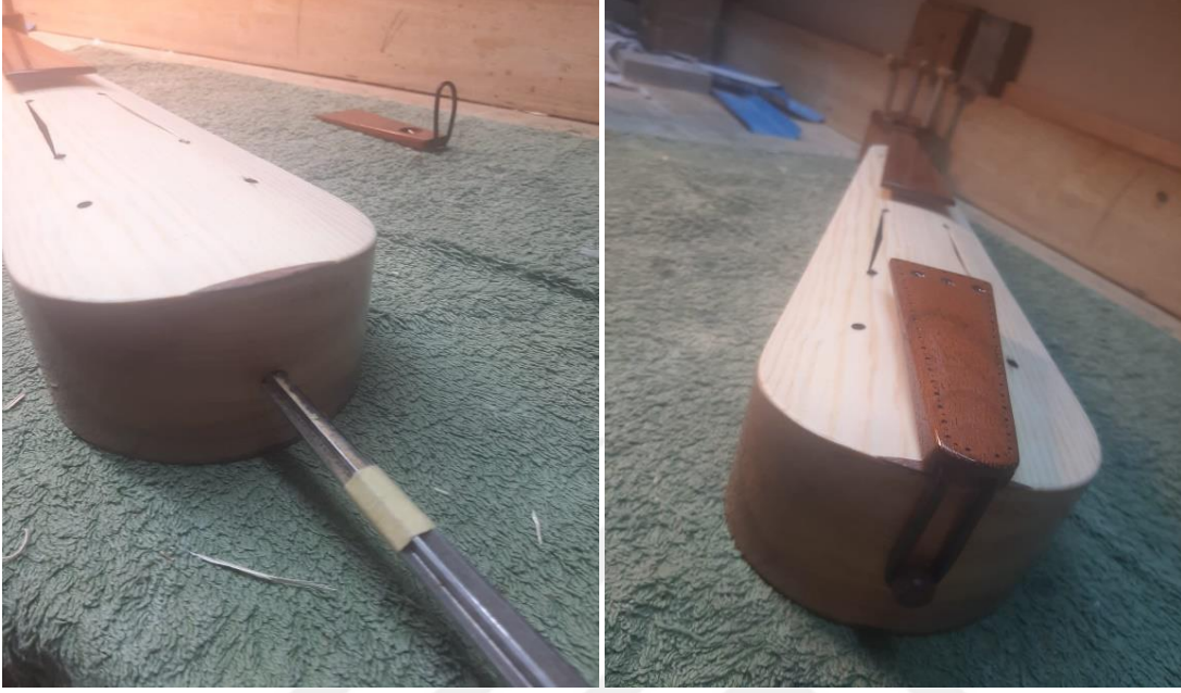
Şekil 24. Kuyruk düğmesi yerinin açılması ve montajı (Fotoğraf Ceyhun Demir, 2022).
