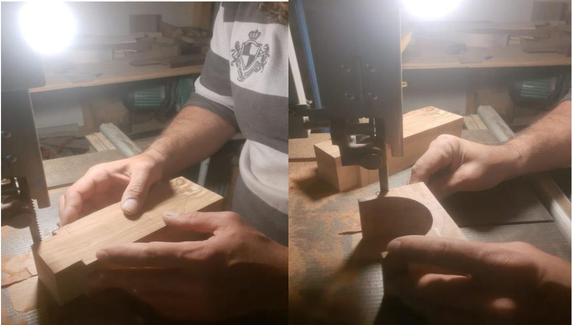
Şekil 17. Karadeniz Kemeçesi Yapımı: Üst ve alt takozların şerit testere ile kesilmesi (Ceyhun Demir Kişisel Fotoğraf Arşivi), (Demir, 2022).
