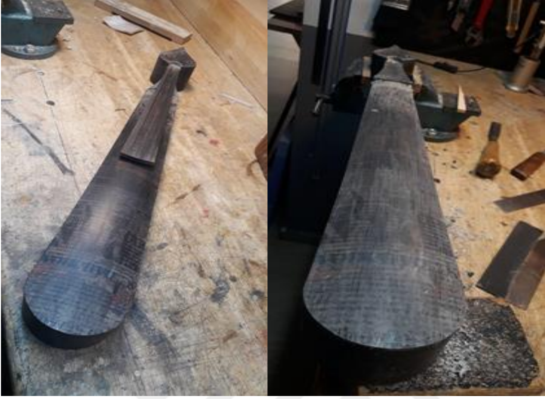
Şekil 35. Kapak (ses tablası) bölümü ve klavyenin yapıştırılması. (Fotoğraf Ceyhun Demir, 2022).
