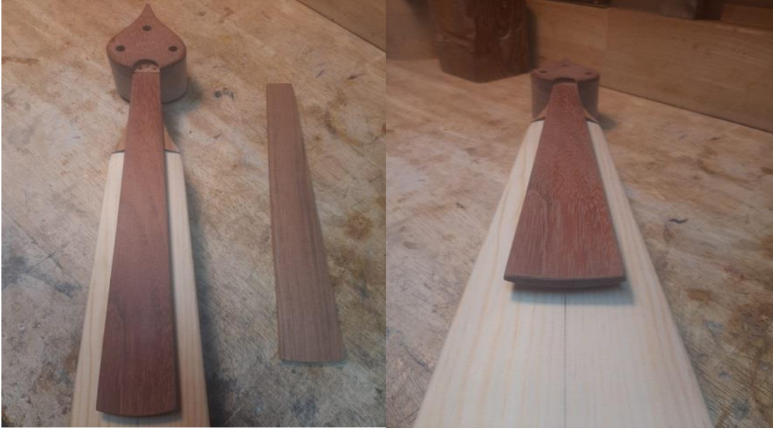
Şekil 21. Tuşe'nin (kravat) hazırlanması (Fotoğraf Ceyhun Demir, 2022).
