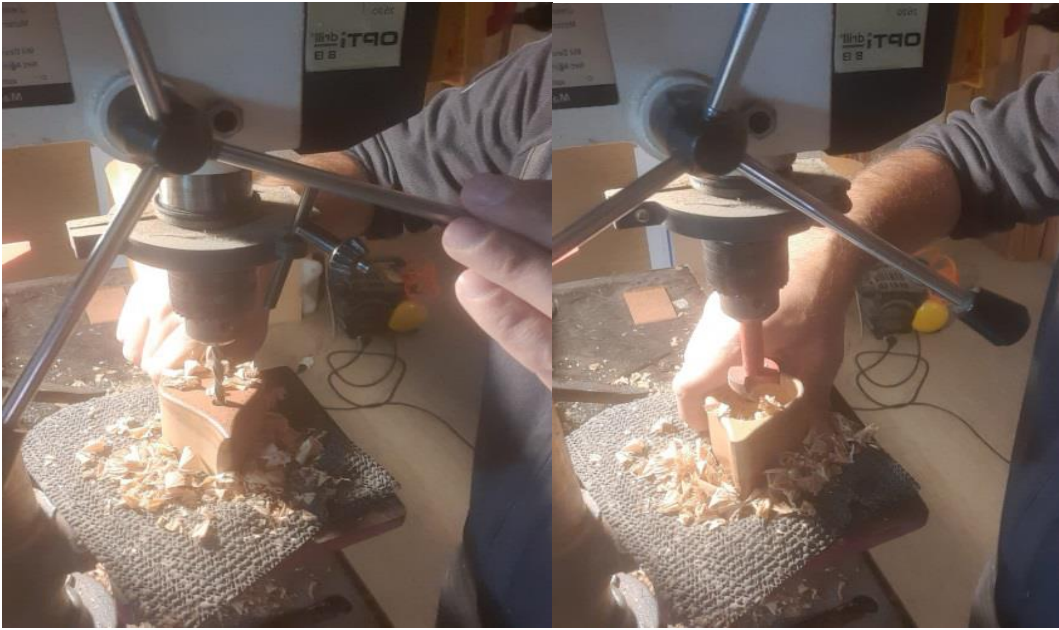
Şekil 23. Burguluğun şekillendirilmesi ve içinin oyulması (Fotoğraf Ceyhun Demir, 2022).
