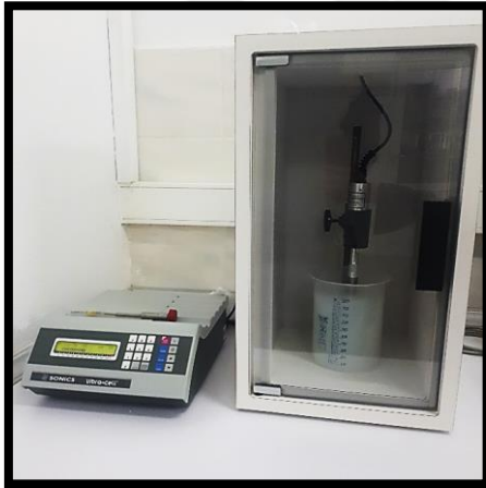
Şekil 31. Sonikatörde karıştırılan nanopartiküller (Akbaý, 2023)
